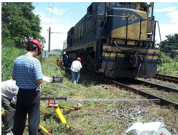
Figura 4.1 – Leitura do extensômetro da Viga Benkelman ao passar a locomotiva
