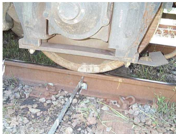
Figura 4.2 – Detalhe da roda da locomotiva no ponto de prova
