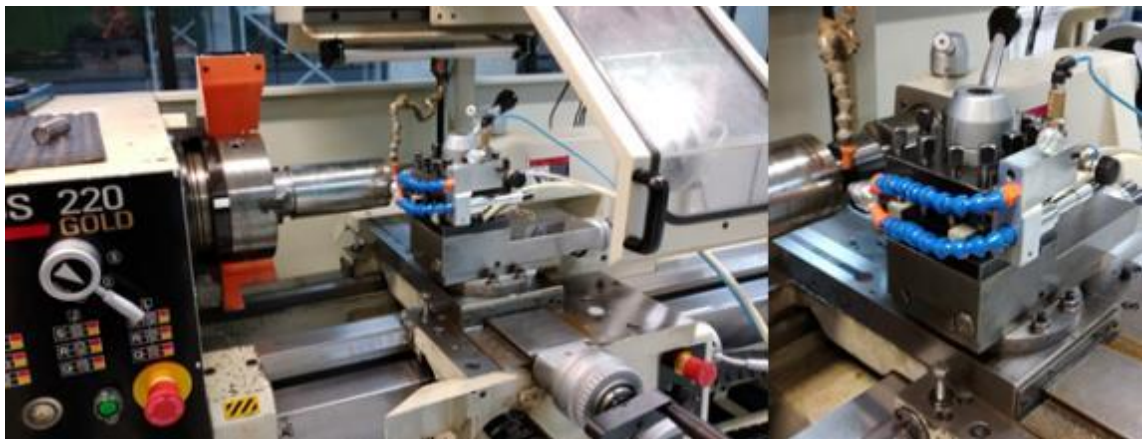
Figura 22 - Sistema MQCL montado no Torno
