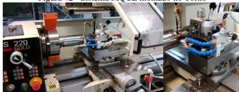
Figura 42 - Sistema MQCL montado no Torno
