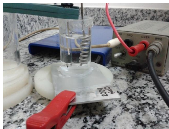
Figura 9: Sistema da célula eletroquímica utilizada.
