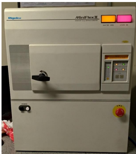
Figura 23 – Equipamento MiniFlex II utilizado para a caracterização das amostras de QDs de ZnO.
