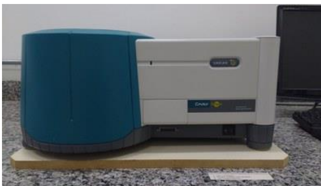
Figura 18 – Espectrofluorímetro utilizado nas medições de emissão fluorescente das amostras.
