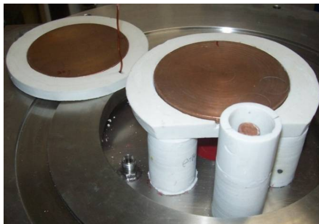
Figura 21. Os eletrodos, o cátodo e o ânodo, estão encapsulados com porcelanas
