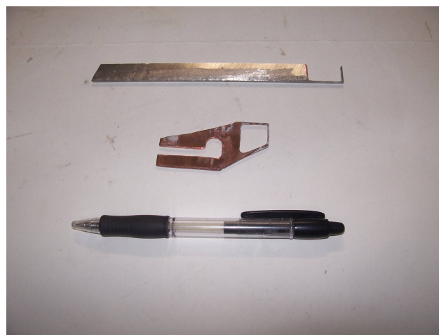
Figura 15. Ferramentas de corte utilizada no torno
