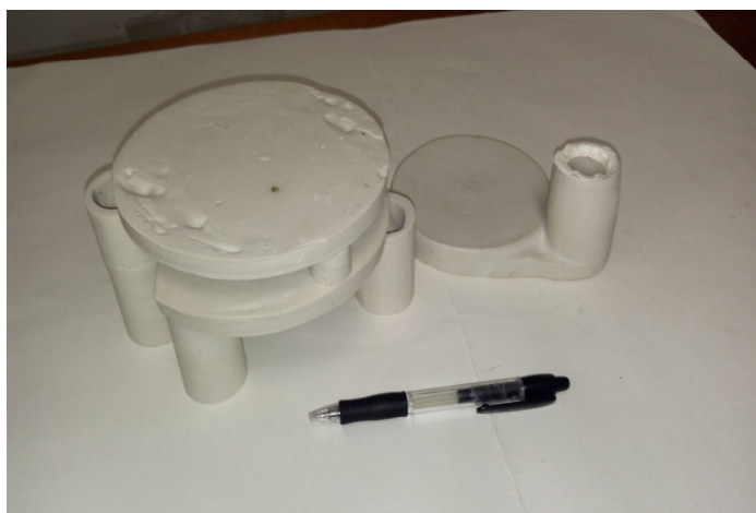
Figura 20. As porcelanas após o processo de vitrificação apresenta uma coloração acinzentada.
