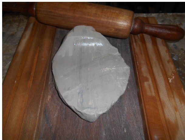
Figura 11. A porcelana é composta de 40% de caulim, 25% de quartzo, 25% de feldspato e 10% de argila.
