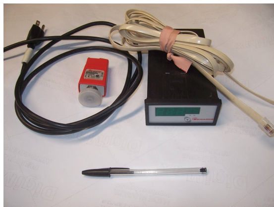
Figura 6 O sensor APG10-XM, módulo controlador digital APG para leitura das pressões dentro da câmara.
