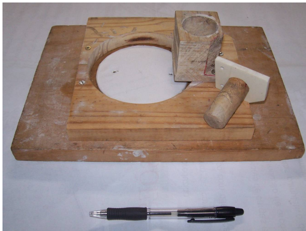
Figura 12. Bipartição do molde para facilitar na extração do modelamento da argila para a confecção da porcelana
