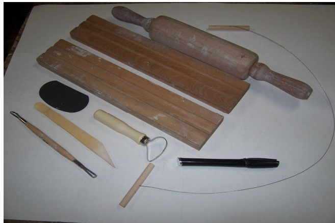
Figura 13. Utensílios utilizados para compactar e cortar a argila em diversos formatos(rolo, travessas, lâmina de corte, ferramentas de acabamento, fio de corte).
