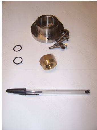
Figura 8 Bucha de estancamento montado com um retentor O-ring.
