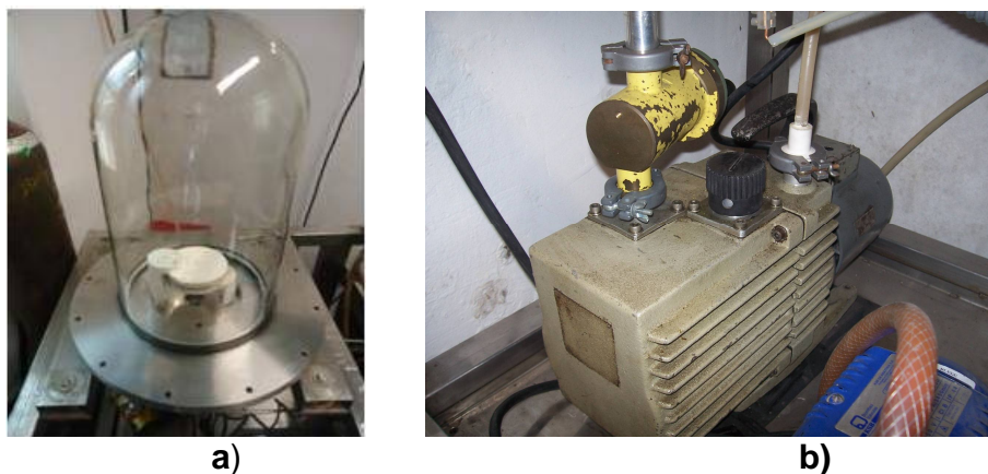
Figura 5 Campânula de vidro montada sobre um disco de aço inox(a); Bomba de vácuo mecânica de palhetas da Alcatel(b).
