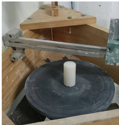
Figura 17. Peças tubulares de porcelana são confeccionadas através de um pino central montado no centro do disco de PVC.
