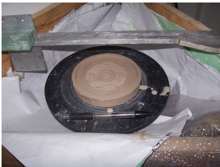
Figura 16. Torneamento de uma peça cilíndrica de argila para encapsulamento dos eletrodos.
