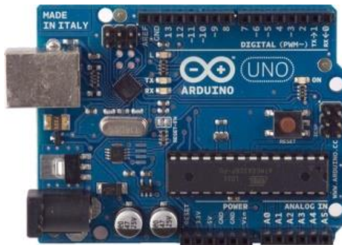
Figura 9: Placa Arduino UNO[34]
