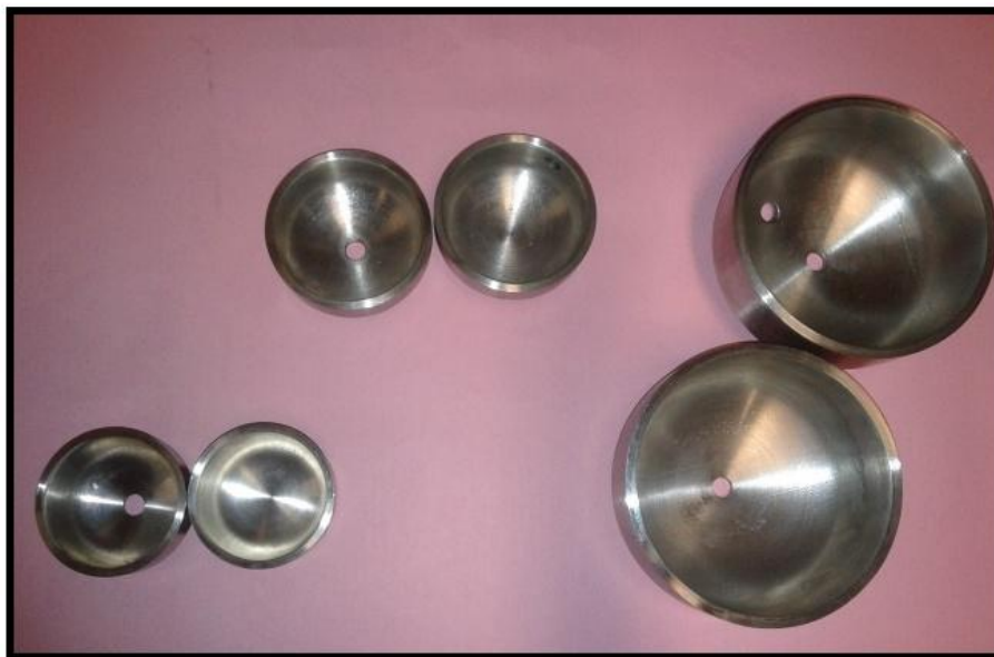
Figura 13- Cap após furação - Separados
