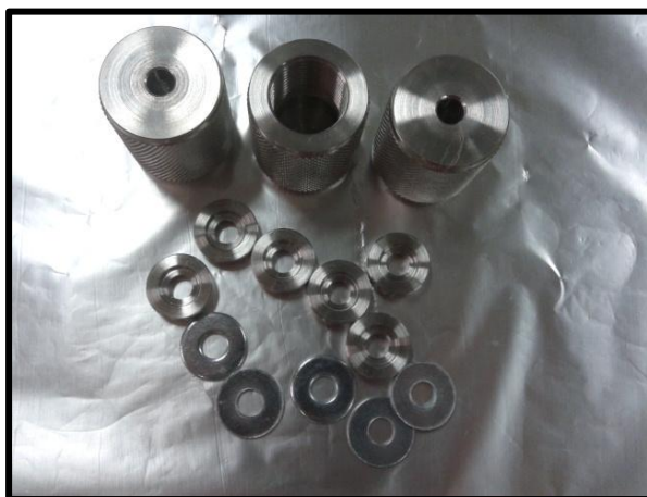
Figura 27- Engate-rápido e Anilhas: após limpeza e jato de nitrogênio
