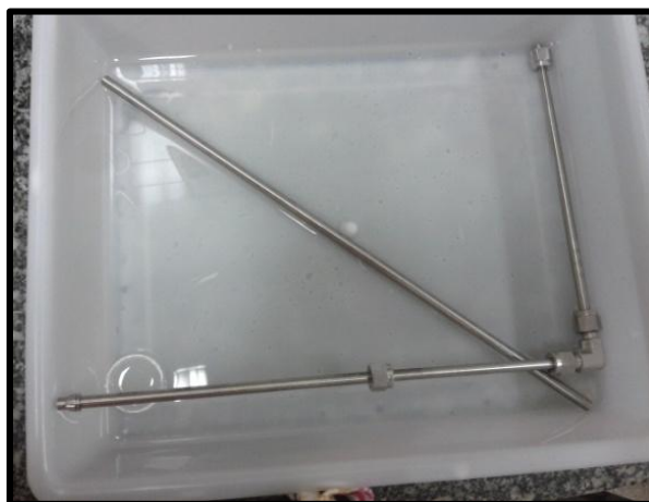
Figura 28- Tubos de 1/4 e Conexões :submersos em Álcool Isopropílico
