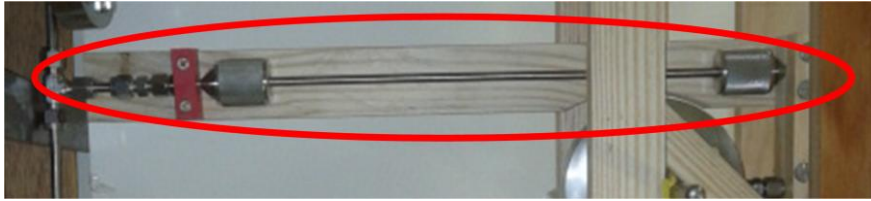
Figura 37- Trava em madeira para engate rápido
