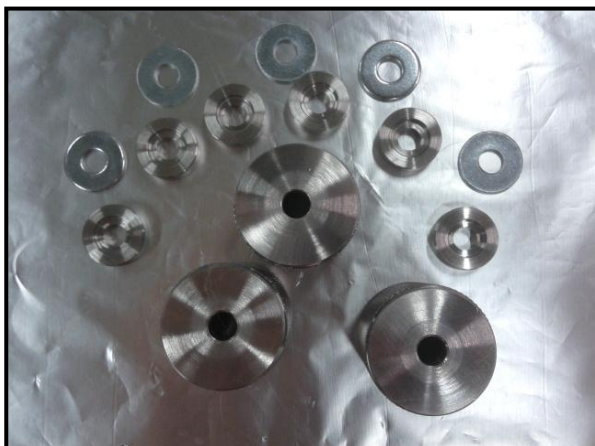
Figura 26 Engate-rápido e Anilhas: após limpeza e jato de nitrogênio
