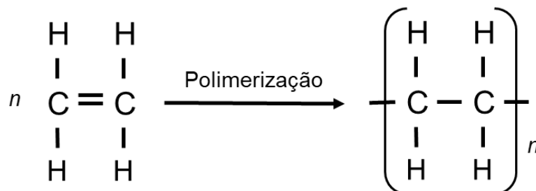
Figura 8. Transformação química do etileno em polietileno por polimerização.
