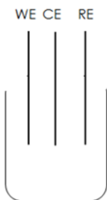
Figura 15: Representação do sistema de três eletrodos imersos no béquer para execução da eletroforese. WE: eletrodo de trabalho. CE: contra eletrodo. RE: eletrodo de referência
