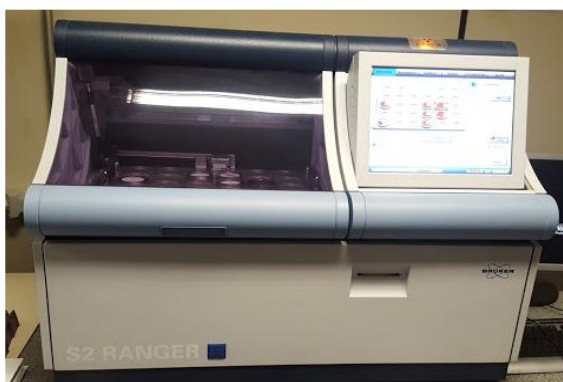
Figura 3.4 – Ensaio de Fluorescência de Raios X: S2 Ranger
