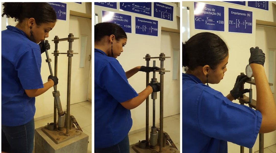
Figura 3.9 – Execução do ensaio Mini-Proctor.
