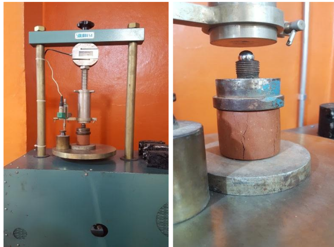
Figura 3.10 – Ensaio de Resistência à Compressão Simples.
