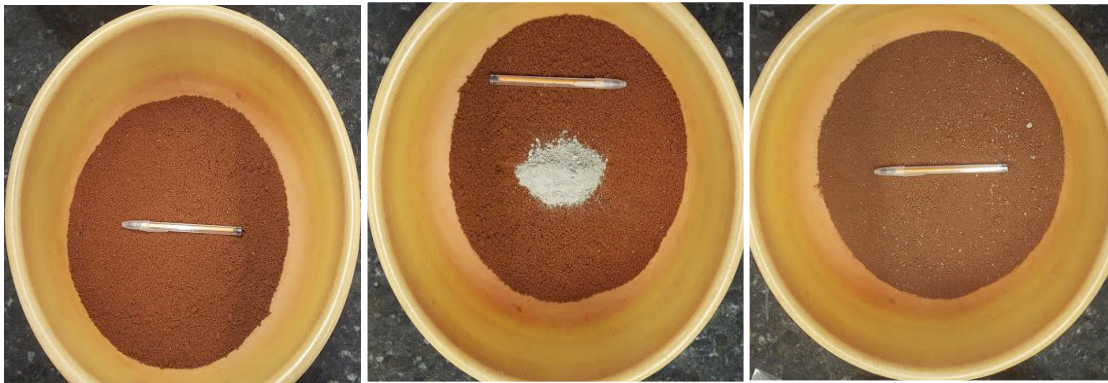
Figura 3.8 – Etapas da mistura Solo-Cinza-Cimento
