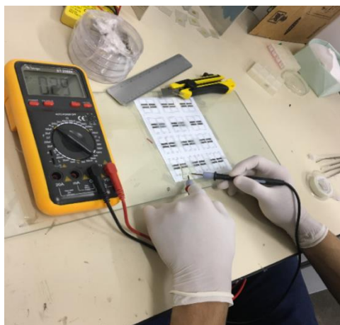
Figura 10 – Detecção do filme fino de ITO com ajuda de um multímetro.
