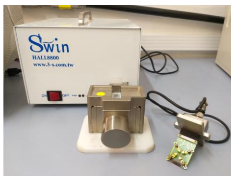
Figura 25 - Equipamento de efeito Hall, com porta amostra com circuito Van der Pauw.
