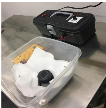
Figura 18 – Aparato spinner utilizado para a deposição dos filmes finos.
