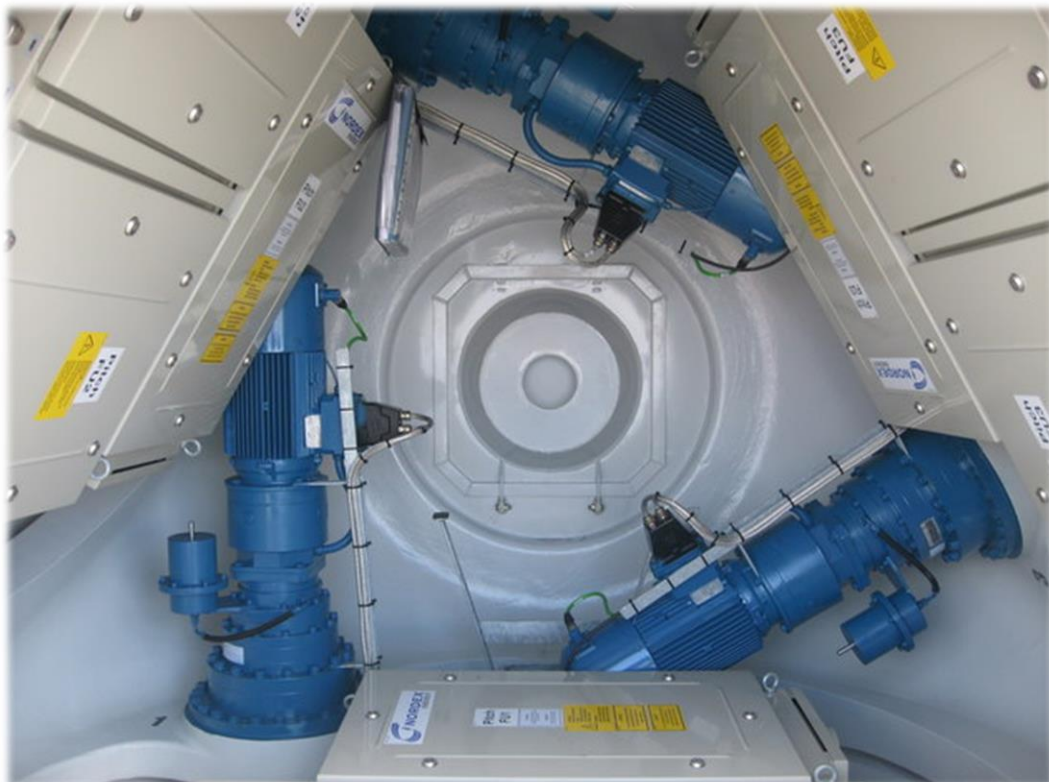
Figura 8 - Mecanismo do ângulo das pás
