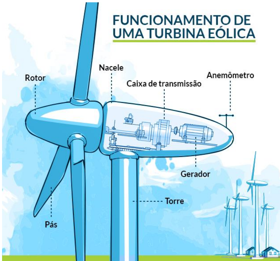
Figura 7 - Principais componentes de uma Turbina Eólica
