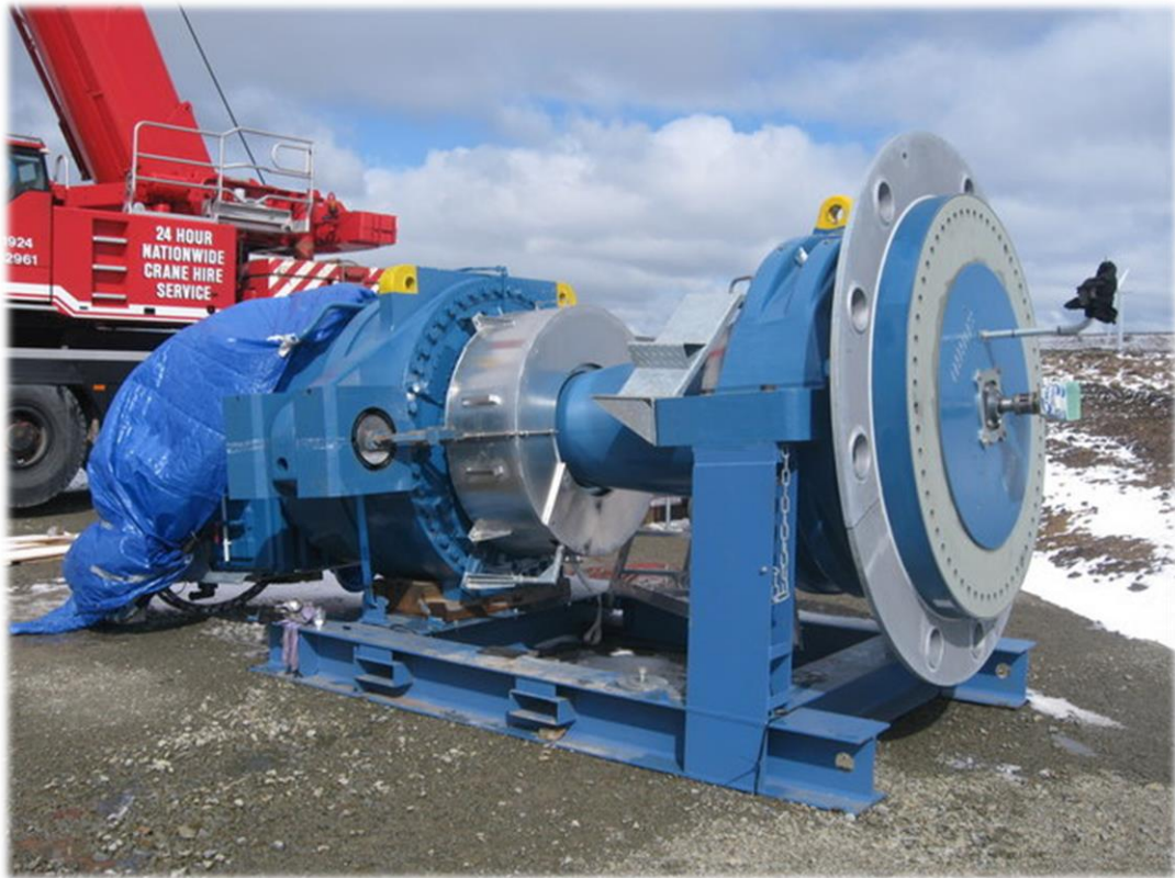
Figura 11 - Eixo de Transmissão, caixa de engrenagens e Disco de Freio
