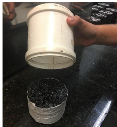
Figura 3.3.1.2 - Corpo de prova envelopado com fita crepe sendo acondicionado no tubo de PVC
