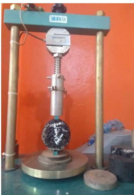
Figura 3.4.2 – Prensa de compressão diametral
