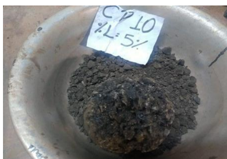
Figura 3.5.2.5 – Detalhe do corpo de prova n.10 após ensaio cântabro
