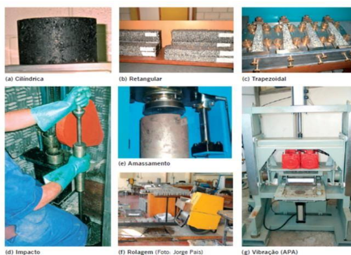
Figura 3.1 – Exemplos de corpos-de-prova de diversas formas e compactadores de misturas asfálticas
