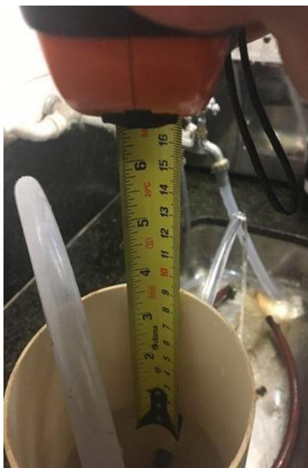
Figura 3.3.1.6 – Determinação da carga hidráulica
