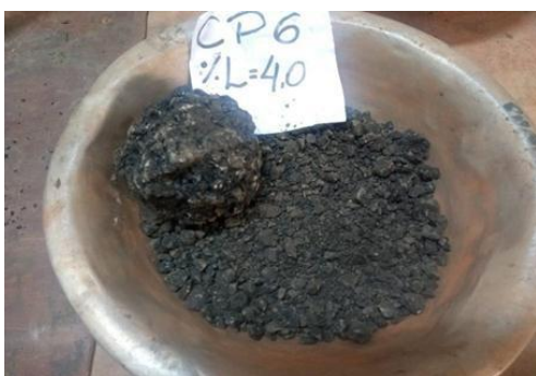
Figura 3.5.2.3 – Detalhe do corpo de prova n.6 após ensaio cântabro
