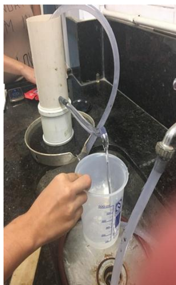
Figura 3.3.1.8 – Determinação da vazão
