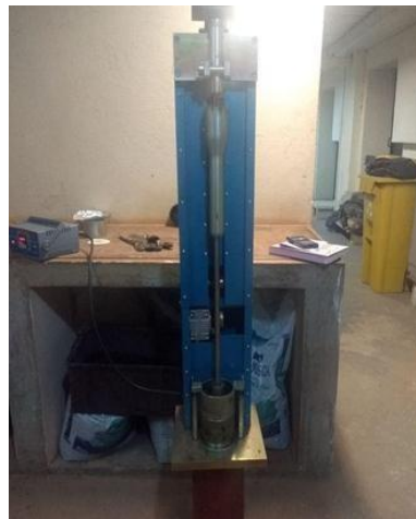
Figura 3.2.10 - Compactador de Marshall Mecânico
