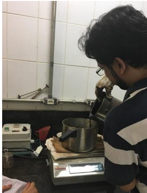
Figura 3.2.8 – Adição do ligante asfáltico ao agregados
