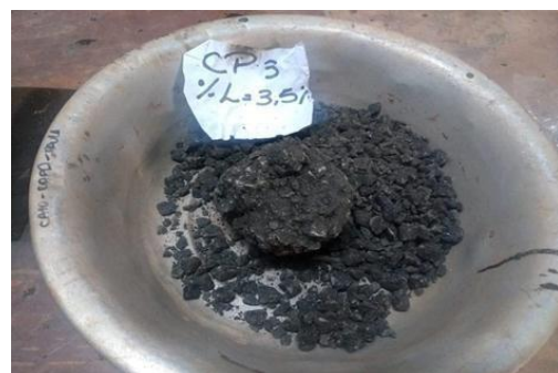
Figura 3.5.2.2 – Detalhe do corpo de prova n.3 após ensaio cântabro
