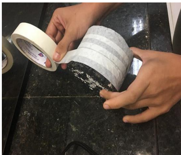
Figura 3.3.1.1 - Corpo de prova envelopado com fita crepe
