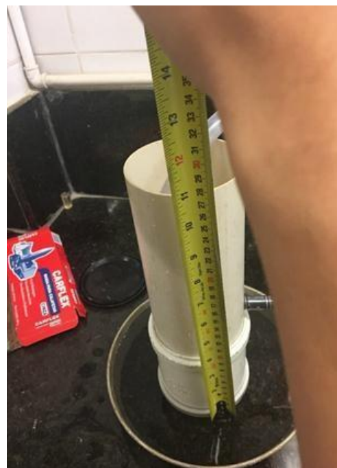
Figura 3.3.1.7 – Determinação da altura entre a borda superior do tubo de PVC e a lâmina d'água da bandeja
