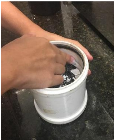
Figura 3.3.1.3 – Preenchimento do vão entre o corpo de prova a lateral do tubo de PVC
