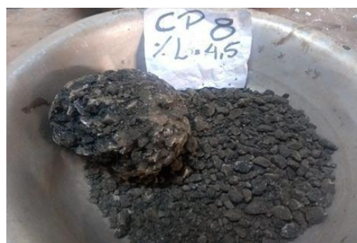
Figura 3.5.2.4 – Detalhe do corpo de prova n.8 após ensaio cântabro
