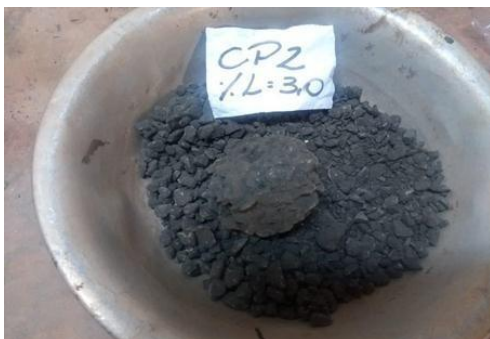
Figura 3.5.2.1 – Detalhe do corpo de prova n.2 após ensaio cântabro
