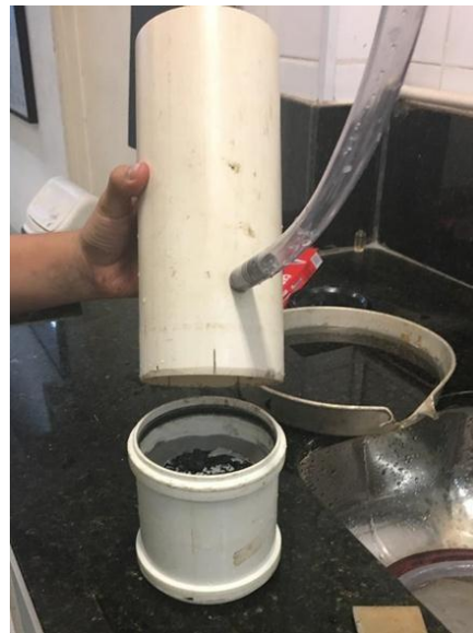
Figura 3.3.1.4 – Tubo prolongador com saída reguladora de altura
