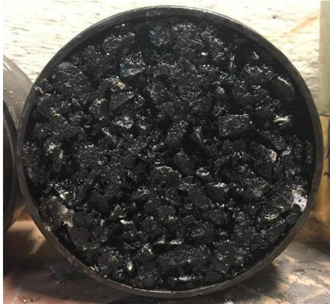
Figura 3.2.12 - Detalhe da superfície da amostra compactada
