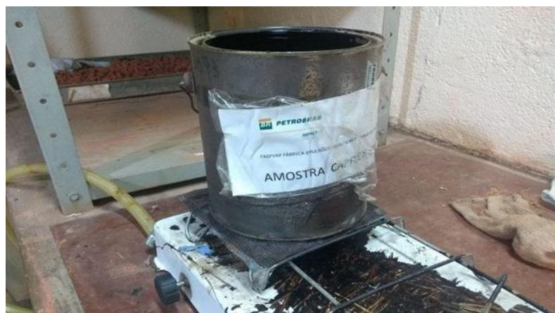
Figura 3.2.7 – Aquecimento do ligante asfáltico com emprego de fogareiro
