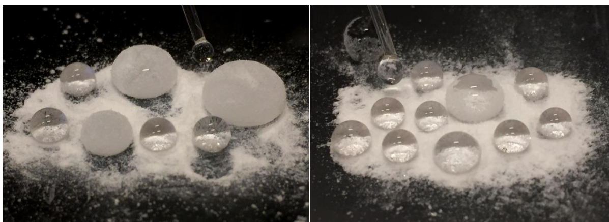
Figura 33 – Aerogéis de sílica apresentando características hidrofóbicas após o processo de sililação: SGTS1 (à esquerda) e SGTS2 (à direita).
