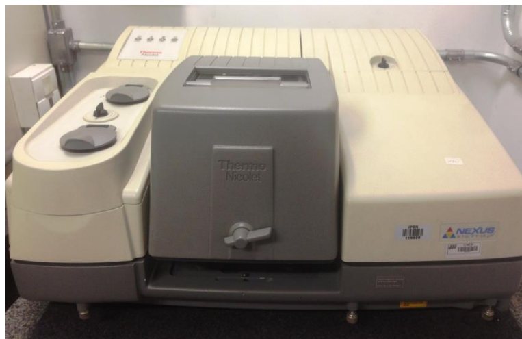
Figura 22 – Equipamento de FTIR utilizado nas análises.
