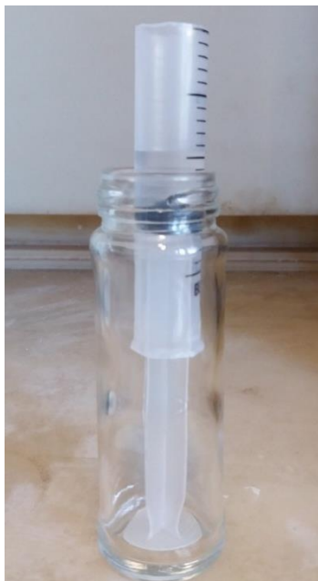
Figura 16 – Molde de seringa adaptado para fabricação do gel.
