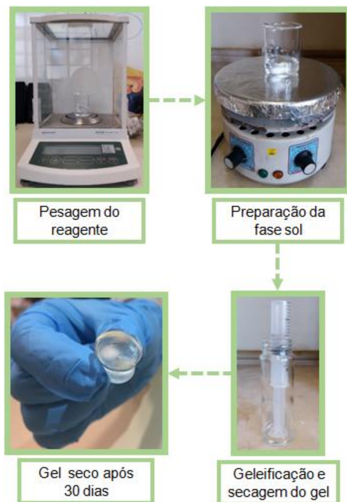
Figura 15 – Fluxograma das etapas de produção das amostras de sílica pela rota sol-gel.
