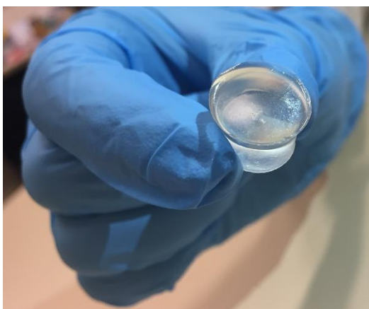
Figura 17 – Amostra do aerogel de sílica após geleificação e envelhecimento em pressão e temperatura ambiente.
