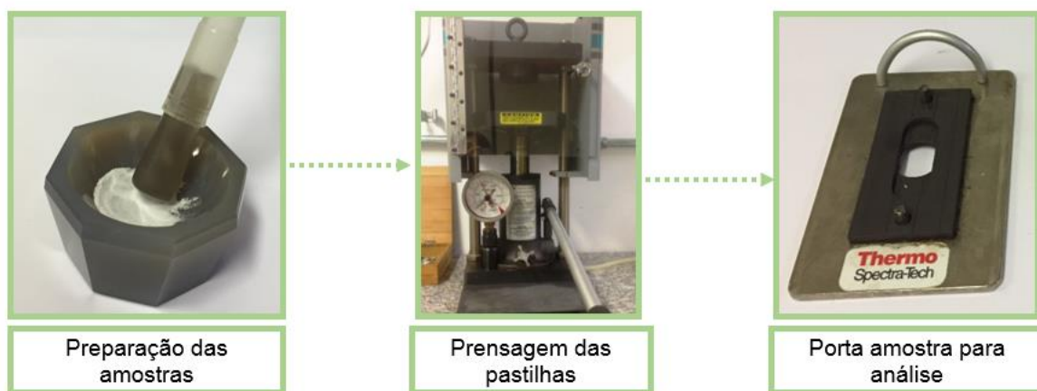
Figura 21 – Imagens do procedimento de preparação das amostras para análise de FTIR.
