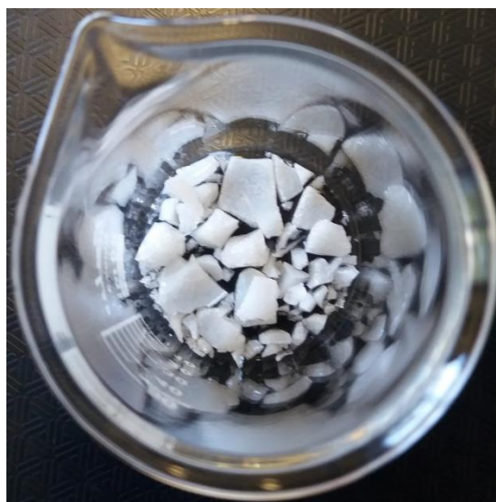
Figura 19 – Amostras de aerogéis de sílica após a etapa de secagem.
