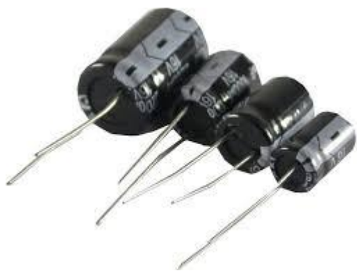
Figura 8 - Capacitor Eletrolítico
