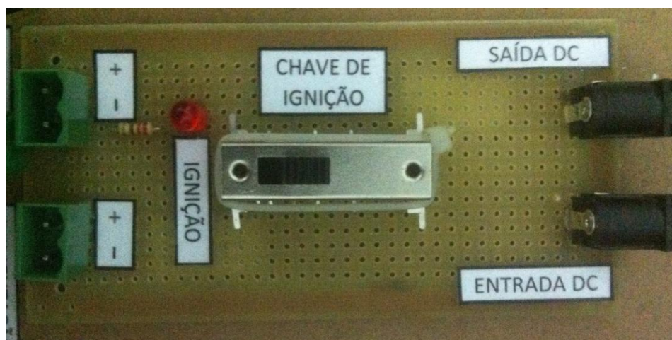
Figura 35 - Chave de Ignição montada e etiquetada
