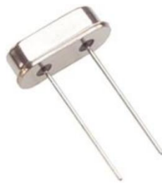
Figura 6 - Cristal Oscilador
