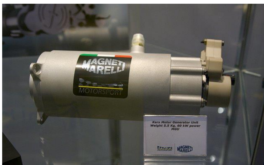
Figura 24: Sistema Kers empregado na Fórmula 1 (Magnetti Marelli)
