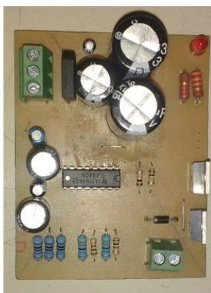
Figura 30- Placa da fonte montada.
