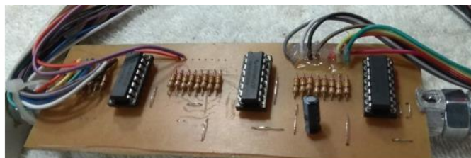
Figura 29- Placa dos registradores montada.
