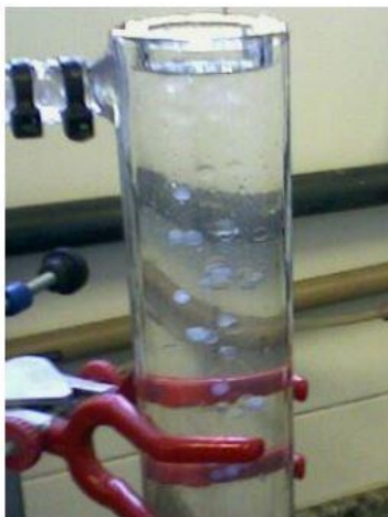
Figura 13: Início da reação de gelificação interna na formação de microesferas.[9]
