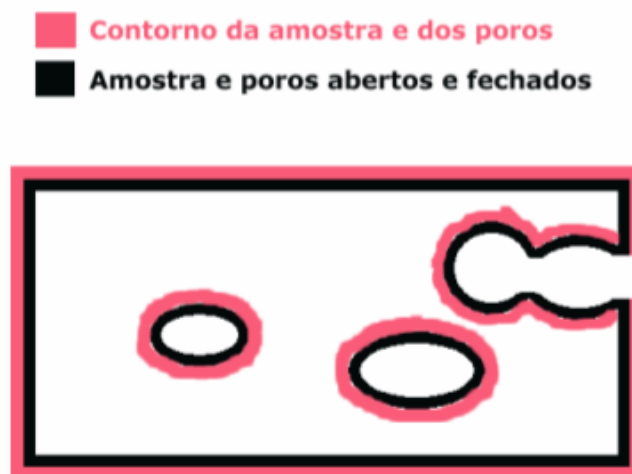
Figura 7: Esquematização de poros abertos e fechados. [16]
