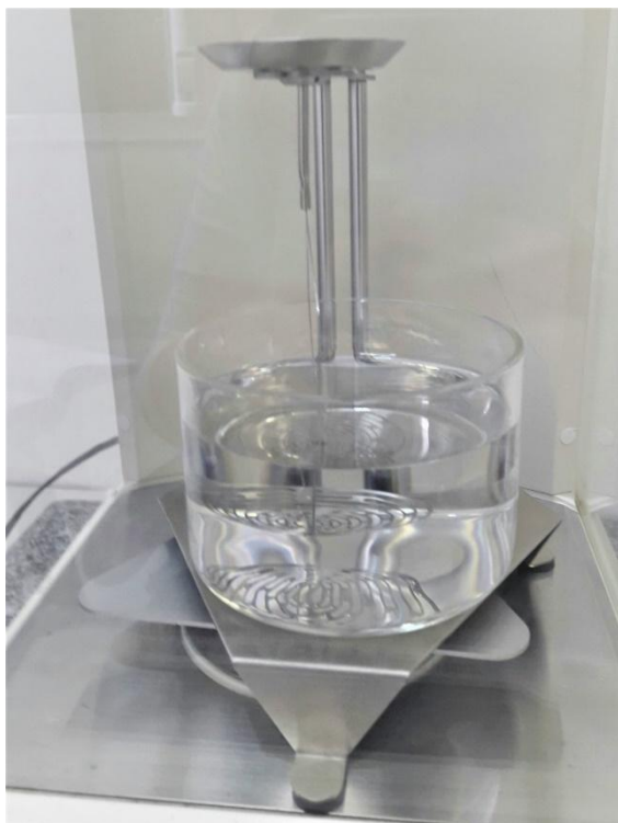
Figura 8: Aparato para a medida de densidade pelo método de Arquimedes.
