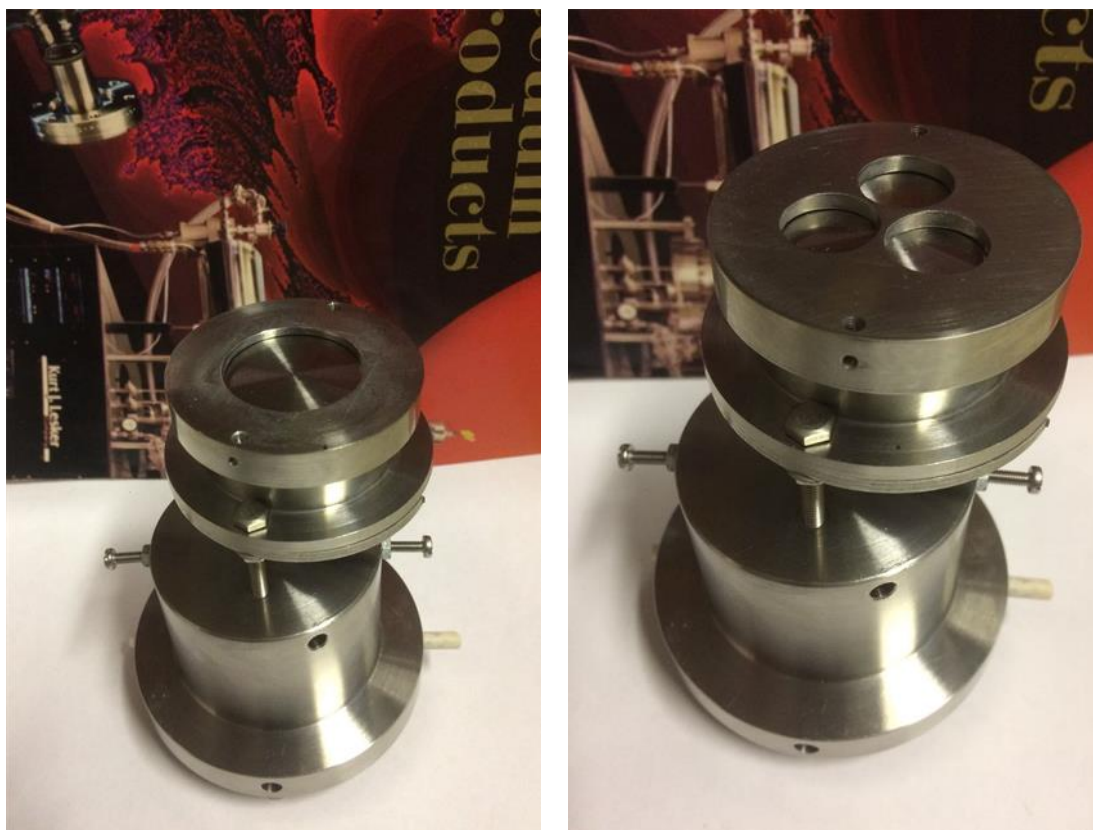
Figura 16 Forno com suporte para amostras.
