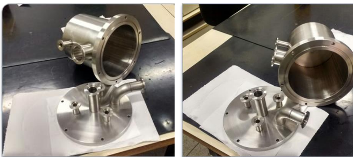
Figura 7 Tampa e câmara usinadas.
