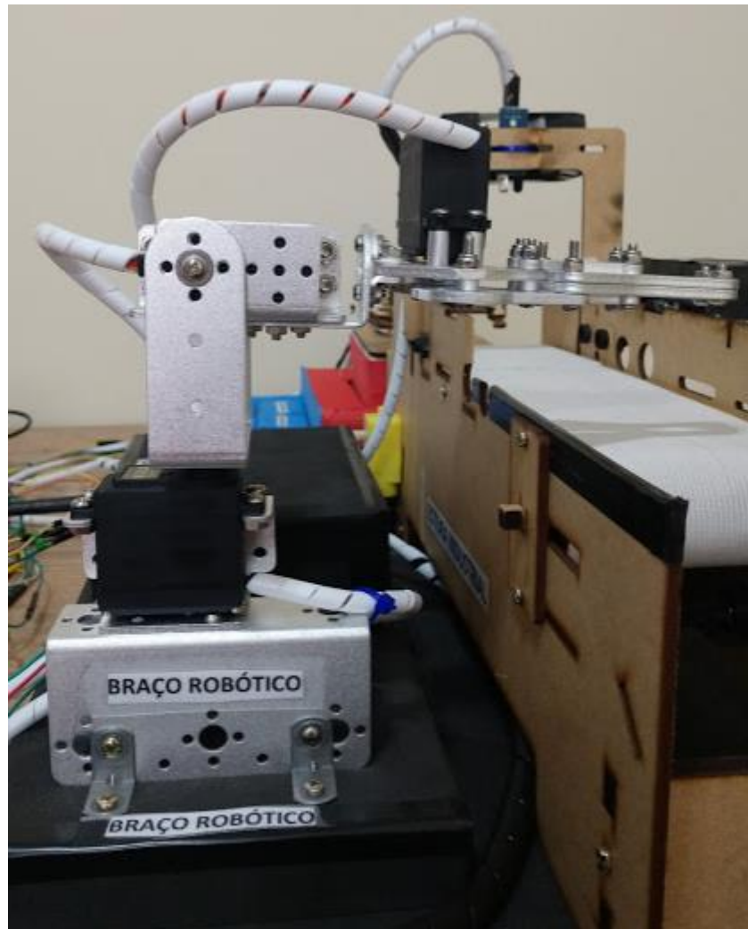
Figura 41 - Braço robótico posição de colocar embalagens na esteira.
