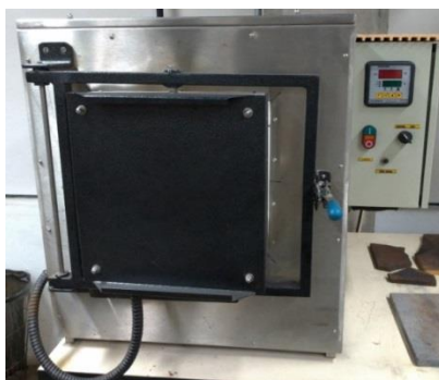
Figura 19: Forno mufla FLYEVER FE50RPN. Laboratório de Materiais para Construção Mecânica, Fatec-SP.
