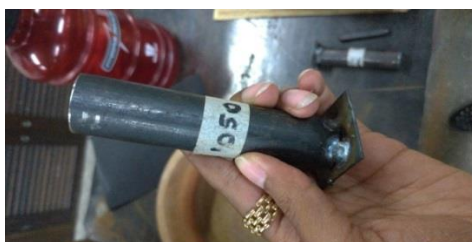
Figura 17: Amostra SAE1050 com chapa soldada pelo processo MAG.
