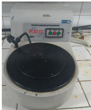
Figura 28: Politriz lixadeira metalográfica PL02 ET Teclago. Laboratório de Materiais para Construção Mecânica, Fatec-SP.
