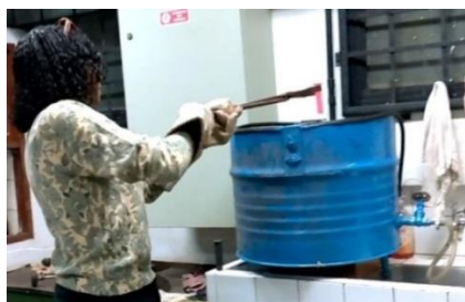
Figura 20: Amostra SAE1050 sendo transportada do forno ao dispositivo de ensaio Jominy. Laboratório de Materiais para Construção Mecânica, Fatec-SP.
