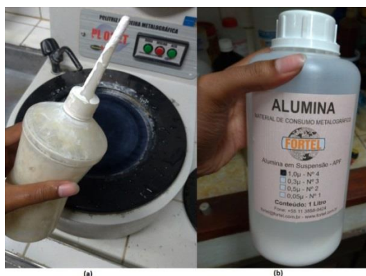
Figura 29: (a) Pisseta com alumina e politriz com feltro de polimento. (b) Reagente alumina Fortel. Laboratório de Materiais para Construção Mecânica, Fatec-SP.
