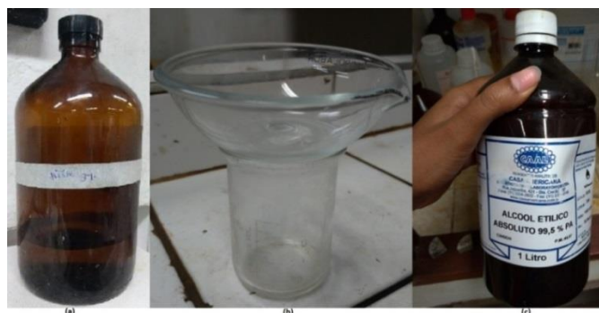
Figura 30: (a) Nital 2%. (b) Bequer com capsula de vidro. (c) Alcool Etílico 99,5% PA Gaal. Laboratório de Materiais para Construção Mecânica, Fatec-SP.
