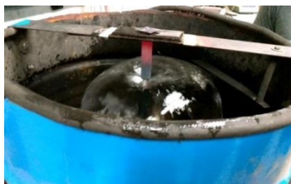
Figura 21: Amostra SAE1050 sendo resfriada no dispositivo Jominy. Laboratório de Materiais para Construção Mecânica, Fatec-SP.
