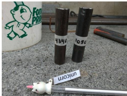
Figura 16: Amostras de SAE1050 e SAE4340 cortadas na cortadora metalográfica CM80. Laboratório de Materiais para Construção Mecânica, Fatec-SP.
