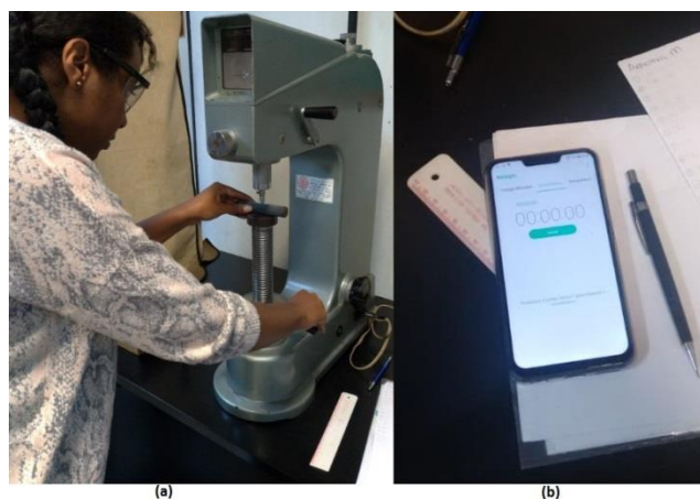
Figura 25: (a) Análise de durezas no durômetro Officine Galileo A -200. (b) Cronômetro do celular ASUS. Laboratório de Materiais para Construção Mecânica, Fatec-SP.
