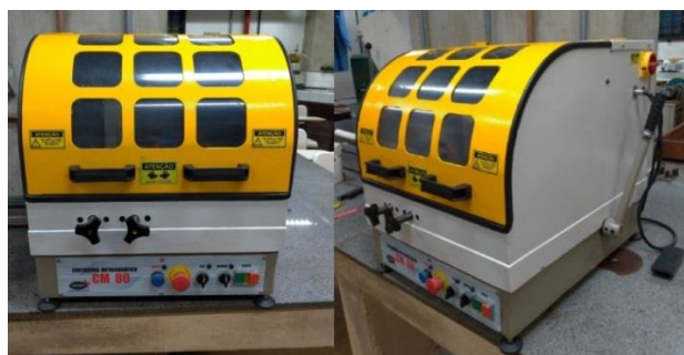
Figura 15: Cortadora metalográfica CM80. Laboratório de Materiais para Construção Mecânica, Fatec-SP.
