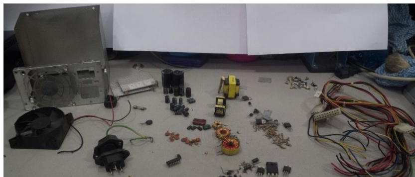
Figura 4 - Fonte de PC genérica desmontada. Fonte: Tavares, M.V.
