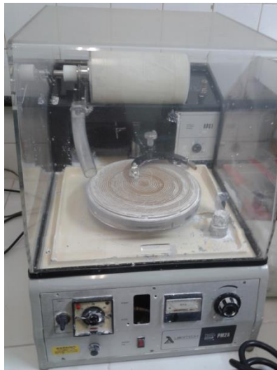
Figura 18 Lapidadora para polimento secundário
