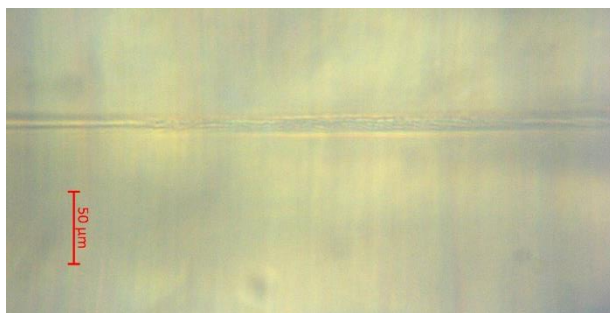
Figura 36 Guia de onda gravado pelas escritas do segundo processo em um mesmo local, observado por microscópio óptico.
