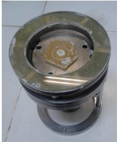
Figura 16 JIG com a amostra fixada no interior
