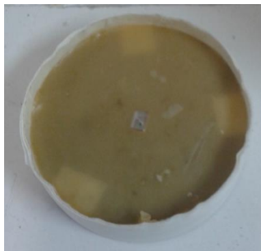
Figura 15 Amostra fixada com cera de abelha no disco metálico
