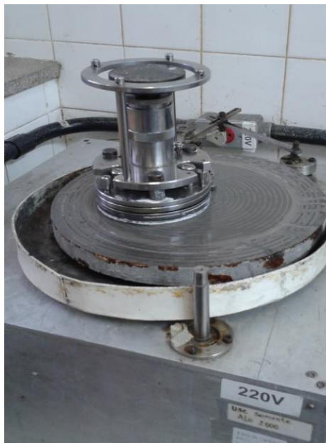
Figura 17 JIG na lapidadora
