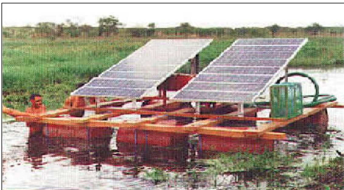
Figura 3. Sistema fotovoltaico de bombeamento de água para irrigação. Fonte: CRESESB, 2000.
