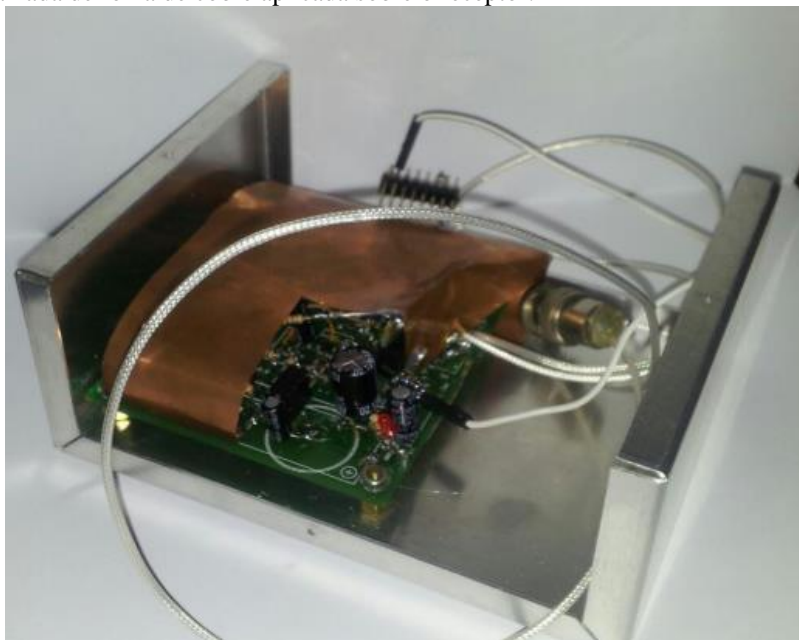
Figura 53 – Camada de folha de cobre aplicada sobre o receptor.
