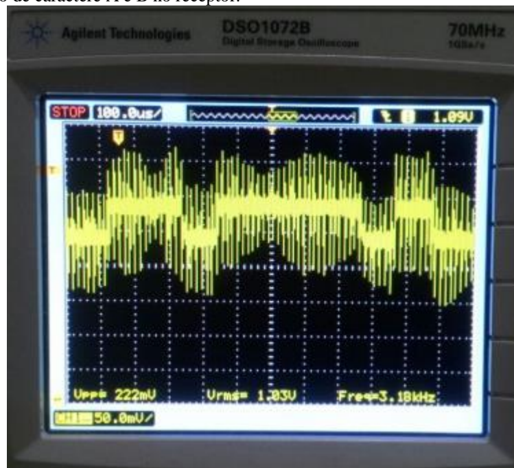
Figura 46 - Envio de caractere A e B no receptor.
