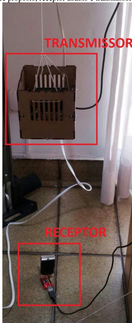
Figura 58 - Montagem do hardware proposto, receptor abaixo e transmissor acima.
