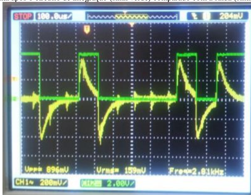
Figura 49 - Sinal após o circuito de integração (sinal verde) comparado com a saída (sinal amarelo).
