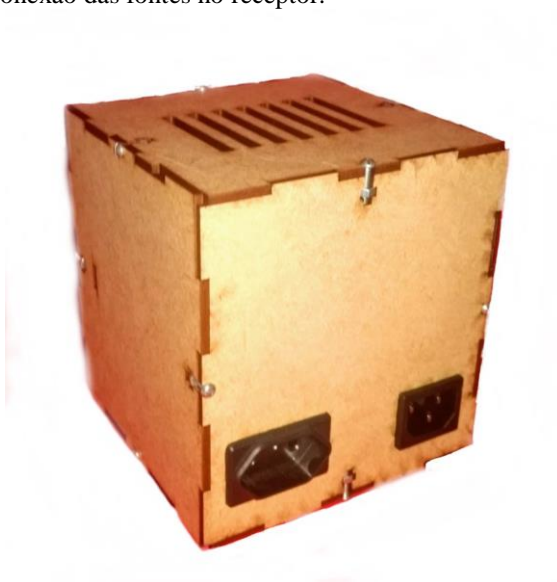
Figura 63 – Tomadas de conexão das fontes no receptor.
