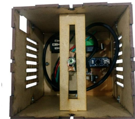
Figura 66 – Disposição dos componentes do receptor.
