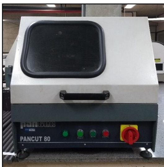
Figura 9: Máquina cortadora de amostras metalográficas PANCUT 80. Laboratório de Materiais de Construção Mecânica, Fatec-SP. Fonte: Acervo pessoal.
