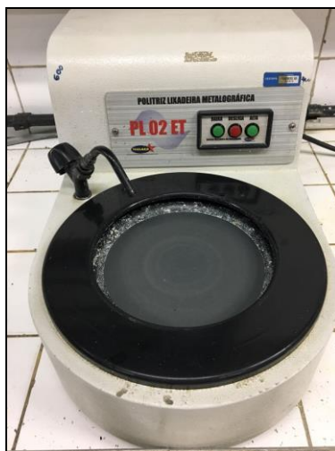
Figura 12: Politriz Lixadeira Metalográfica PL 02 ET, com lixas (280, 400, 600). Laboratório de Materiais para Construção Mecânica, Fatec-SP. Fonte: Acervo pessoal.
