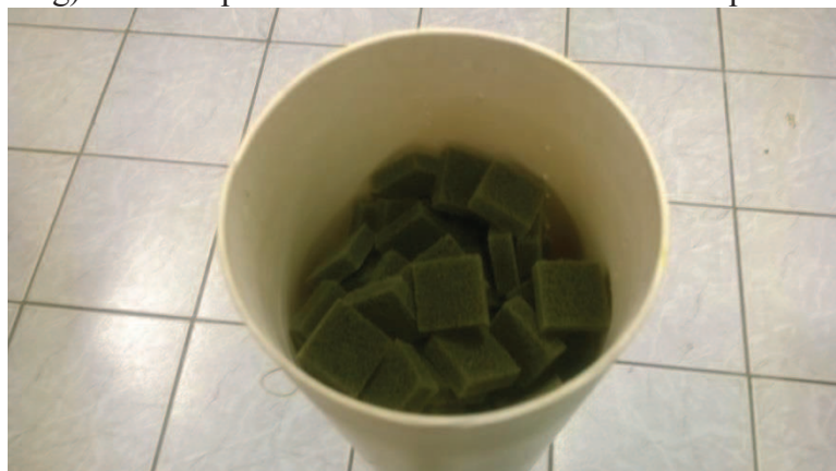
g) cubos de poliuretano utilizados como meio suporte
