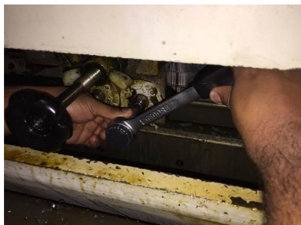
Figura 24 - Depois – Realização do aperto com chave catraca.
