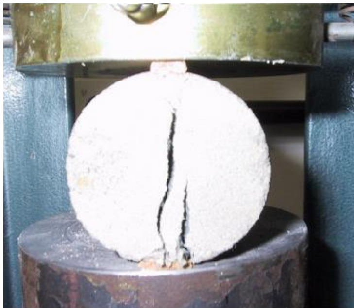
Figura 18. Ensaio de compressão em uma esfera cerâmica
