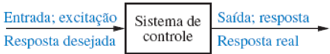
Figura 7 – Descrição simplificada de um sistema de controle
