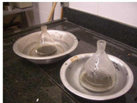
Figura 3.16 – Picnômetros em banho, após fervura, para estabilização da temperatura
