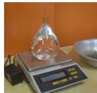
Figura 3.19 – Medição da massa do picnômetro + água
