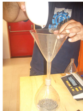
Figura 3.14 – Colocação do material no picnômetro
