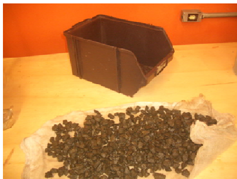
Figura 3.9 – secagem superficial da água na superfície do agregado brita 1
