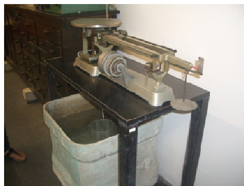
Figura 3.8 – Pesagem hidrostática
