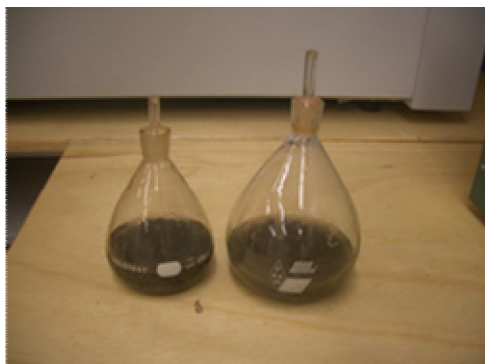
Figura 3.15 – Recobrimento com água destilada a amostra para fervura
