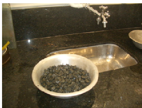
Figura 3.5 – Lavagem da amostra na # > 4,76 mm
