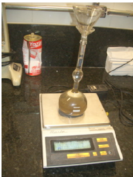
Figura 3.20 – Frasco com querosene com amostra de fíler sendo adicionada
