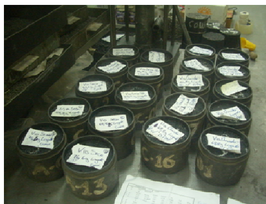
Figura 3.33 – Disposição dos moldes com os corpos-de-prova Marshall após compactação
