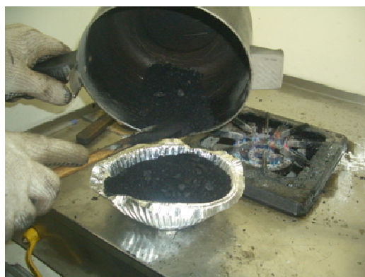
Figura 3.31 – Transferência da mistura asfáltica para estufa
