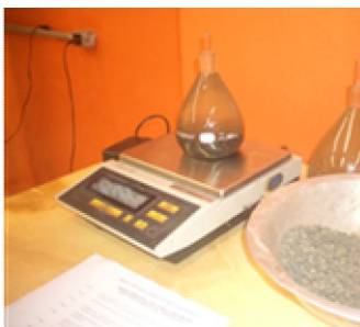
Figura 3.18 – Medição da massa do conjunto: picnômetro + material + água
