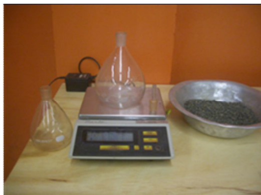
Figura 3.13 – Pesagem do picnômetro vazio e limpo com a tampa
