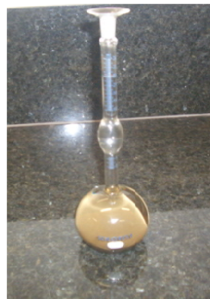
Figura 3.21 – Frasco com amostra de fíler adicionada e com temperatura estabilizada
