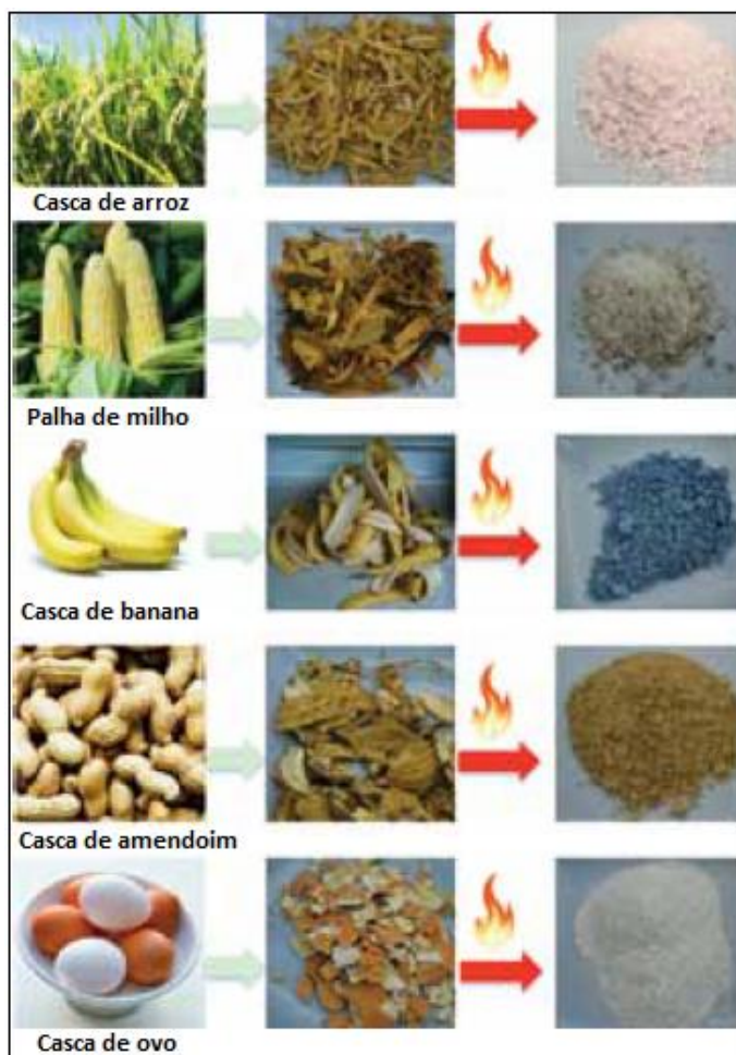
Figura 5 - Resíduos sólidos agroindustriais: matérias-primas à esquerda, seguidas do processo de moagem, e à direita após o tratamento térmico [31].
