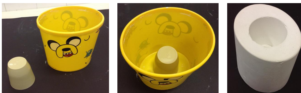
Figura 13 - Esquema de montagem do pré-molde 4 (esquerda e centro) e molde final 5 (direita).
