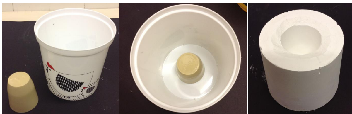
Figura 10 - Esquema da montagem do pré-molde 1 (esquerda e centro) e molde final 1 (direita).
