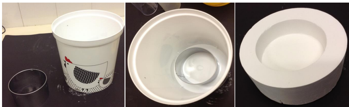
Figura 11 - Esquema da montagem do pré-molde 2 (esquerda e centro) e molde final 2 (direita).
