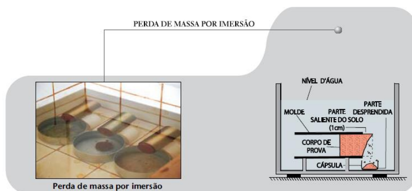
Figura 4.2 – Ilustração e croqui de ensaio da Perda de Imersão
