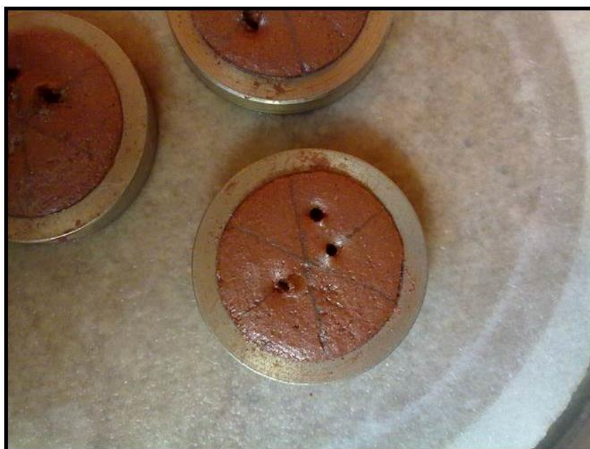
Figura 5.11 – Pastilha após a penetração Fonte: PRÓPRIA (2013)
