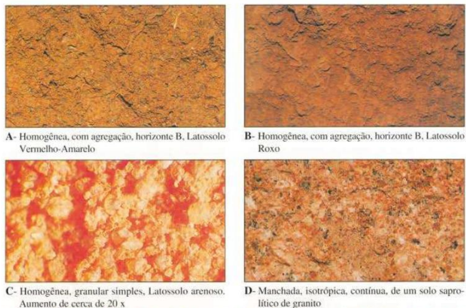
Figura 2.6 – Estrutura e Macro Estrutura dos solos Fonte: Adaptado de NOGAMI e VILLIBOR (1995, p. 25)
