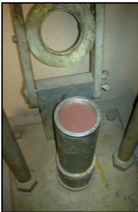
Figura 5.12 – Corpo de prova sendo preparado para compactação
