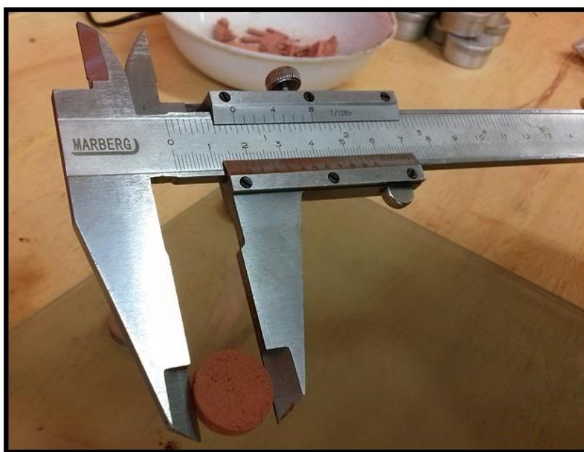
Figura 5.9– Medidas de Contração com Paquímetro
