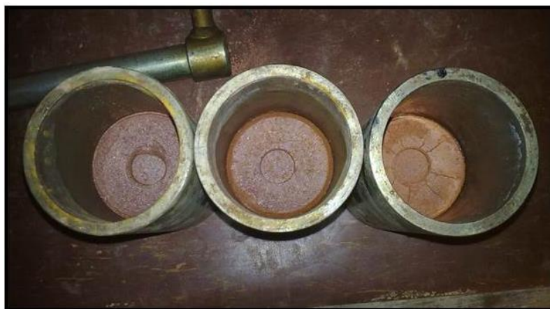
Figura 5.14 – Corpos de prova penetrados pelo ensaio Mini-CBR Fonte: PRÓPRIA (2013)
