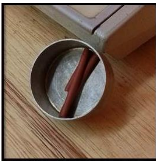
Figura 5.7 – Massa na cápsula de armazenamento para secagem para ensaio de Plasticidade
