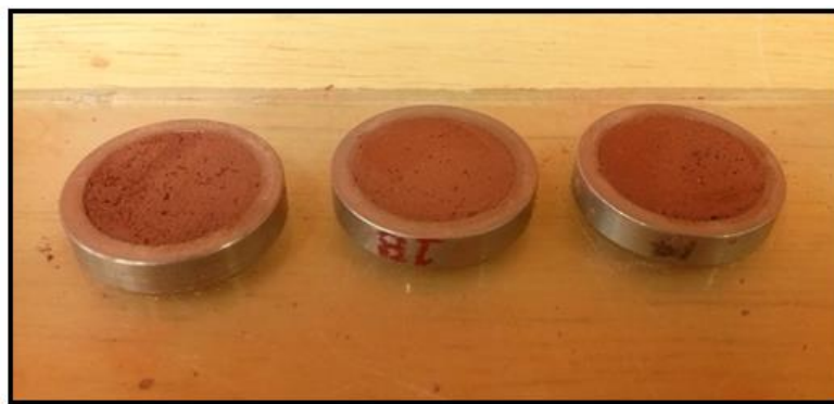
Figura 5.8– Moldagem do solo nos anéis de 20 mm de diâmetro
