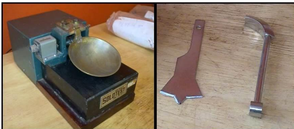
Figura 5.4 – Aparelho de Casagrande (à esquerda) e Cinzeis Fonte: PRÓPRIA (2013)
