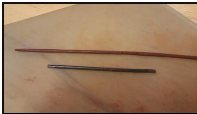
Figura 5.6 – Massa de solo moldada e gabarito para ensaio de Plasticidade
