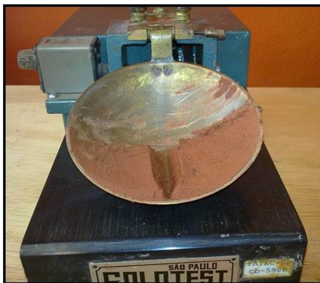
Figura 5.5 – Concha com massa de solo e a ranhura Fonte: PRÓPRIA (2013)
