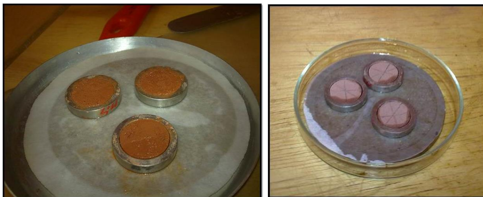
Figura 5.10 – Reabsorção de água das pastilhas na placa porosa Fonte: PRÓPRIA (2013)
