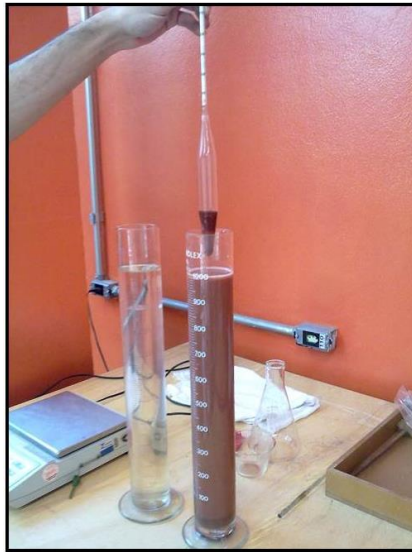
Figura 5.2 – Densímetro e mistura de solo na proveta Fonte: PRÓPRIA (2013)
