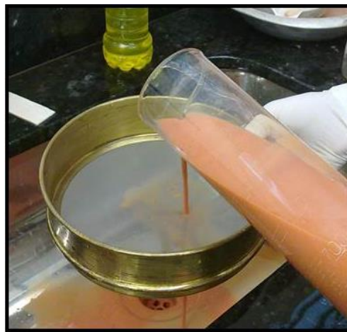
Figura 5.3 – Material lavado na peneira de 0,075 mm de abertura Fonte: PRÓPRIA (2013)
