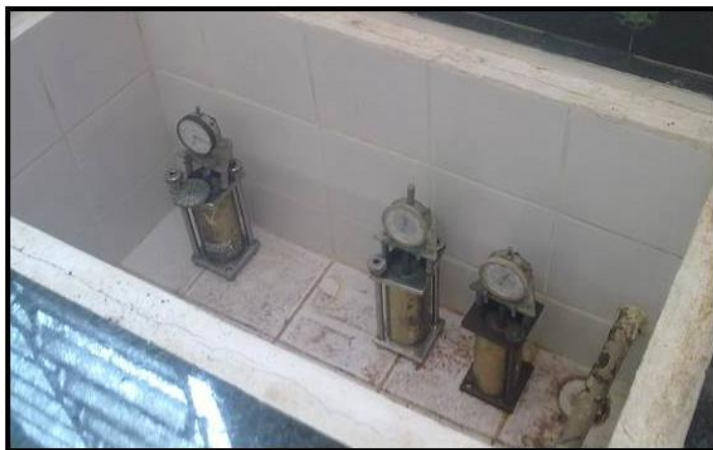
Figura 5.13 – Corpos de prova imersos no tanque para obtenção da expansão Fonte: PRÓPRIA (2013)
