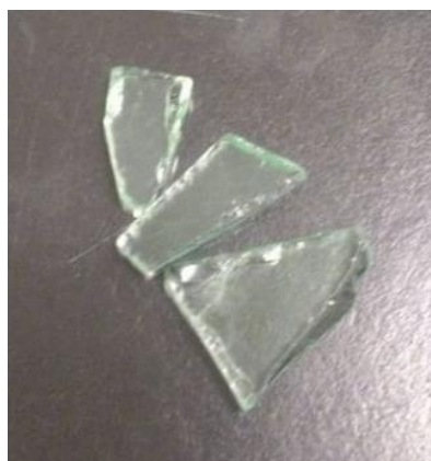
Figura 17 – Vidro após dissolução em dimetilformamida (condição VII).
