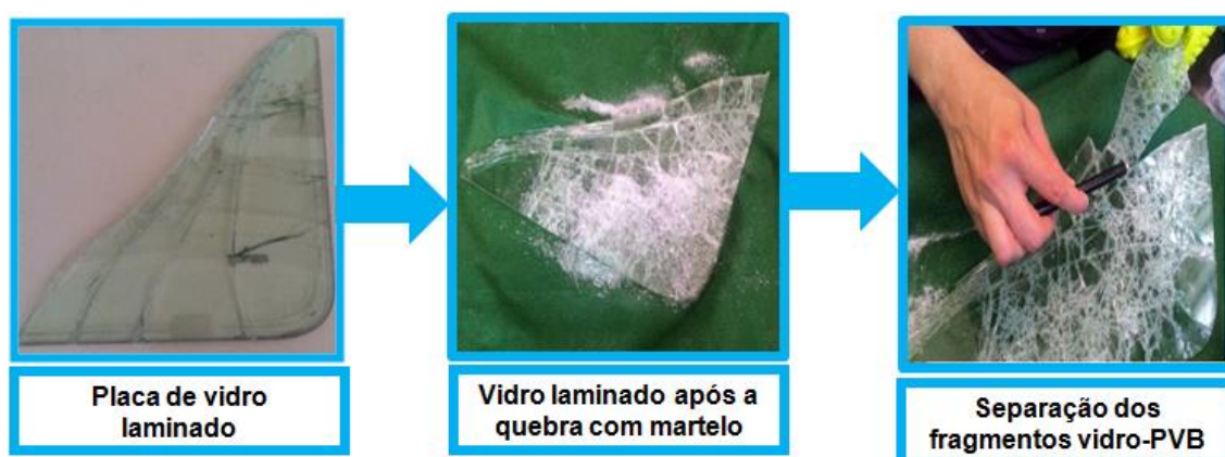
Figura 11 – Vidro laminado antes e depois da quebra com martelo.
