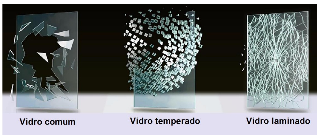
Figura 3 – Fratura em vidro comum, temperado e laminado [26].
