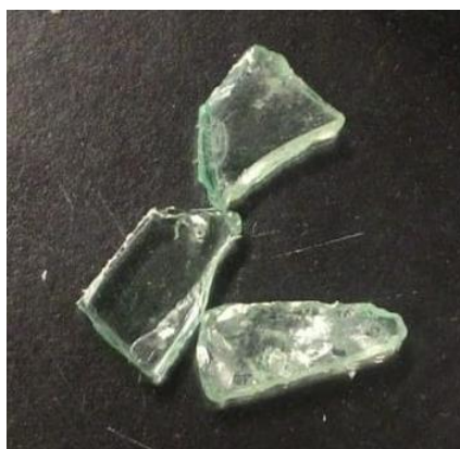
Figura 15 – Vidro após dissolução em álcool etílico e tolueno (condição V).
