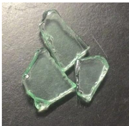
Figura 16 – Vidro após dissolução na condição V, seguida da dissolução em álcool etílico (condição VI).
