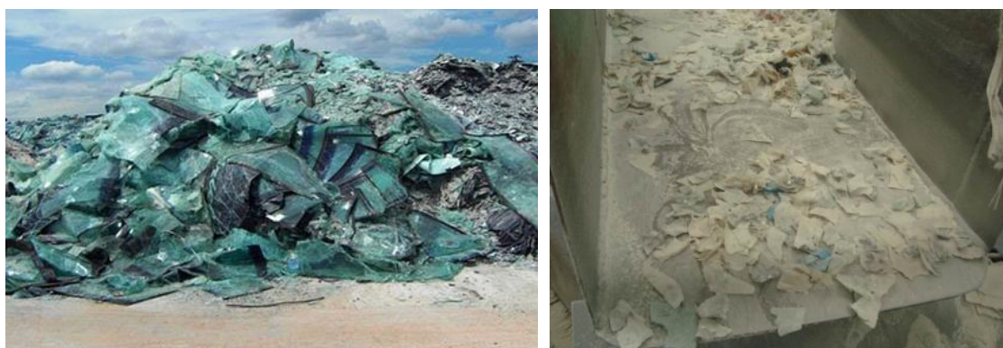
Figura 7 - Vidros de para brisas recebidos pela indústria de reciclagem (à esquerda) e esteira do moinho onde ocorre a separação do vidro e PVB (à direita) [35].
