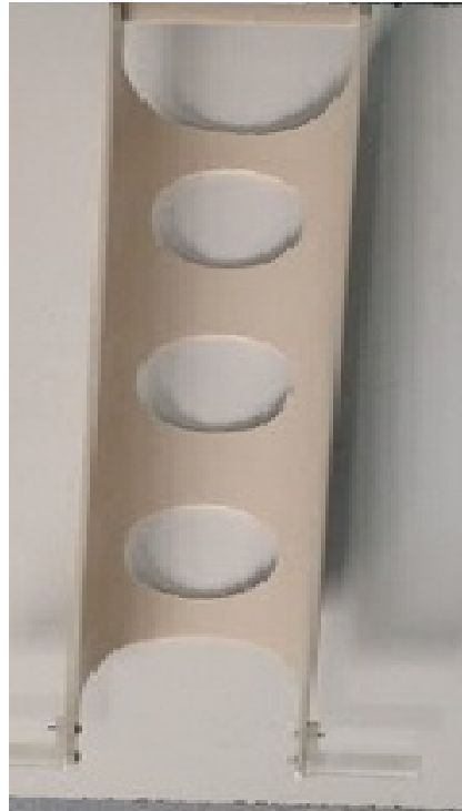
Figura B.9: vista superior do tubo usinado em PVC (próprio autor).
