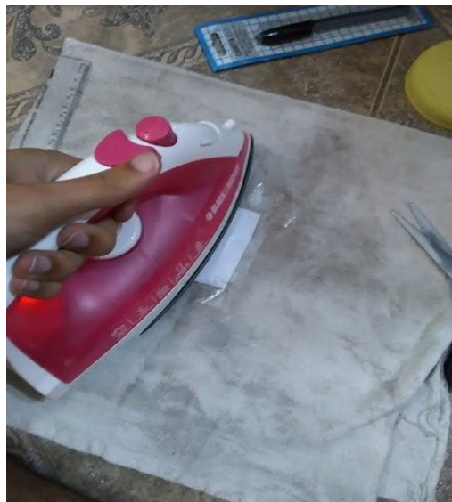
Figura A.3: início da transferência do circuito para a placa (próprio autor).
