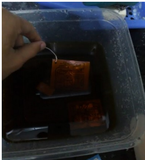
Figura A.5: corrosão da placa de fenolite. (próprio autor).
