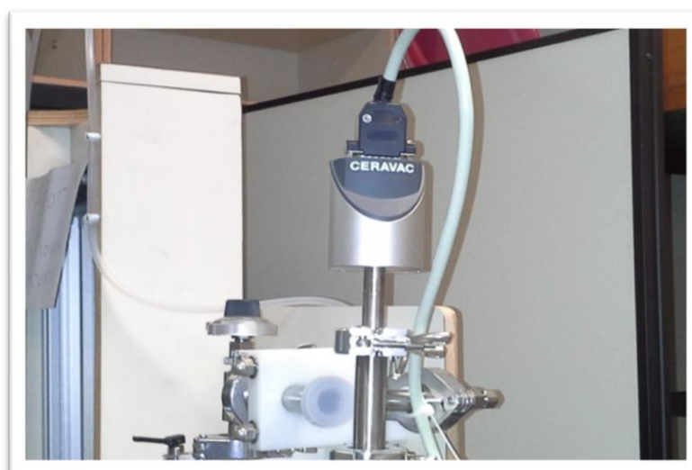
Figura 10 - Medidor de membrana capacitiva Leybold Ceravac Transmitter
