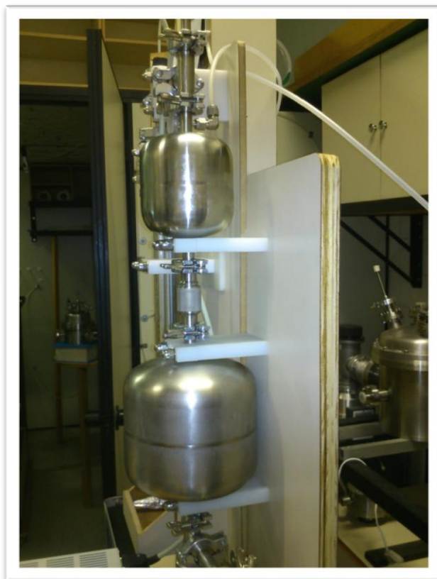
Figura 16 - Detalhamento da fixação do sistema nas placas de madeira
