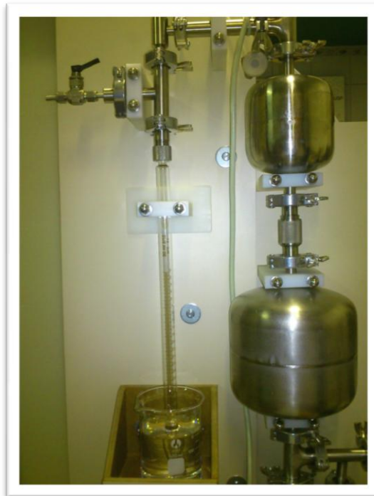
Figura 22 - Fotografia do sistema adaptado para realizarmos a coleta de dados pelo método da pipeta
