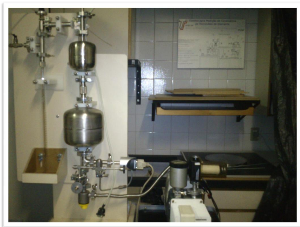
Figura 15 - Fotografia do sistema de vácuo montado
