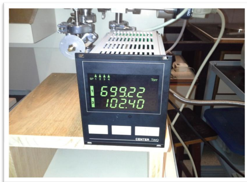
Figura 11 - Unidade controladora Leybold Center Two
