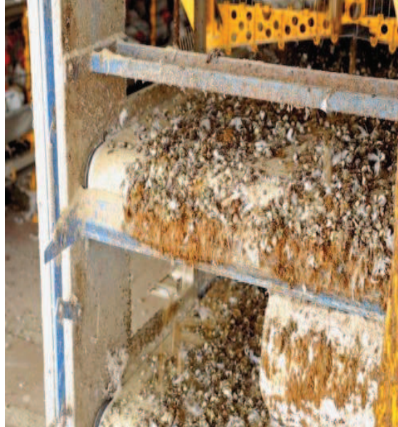
Figura 18: Transportador de cinta automatizado de dejetos - Detalhe do raspador
