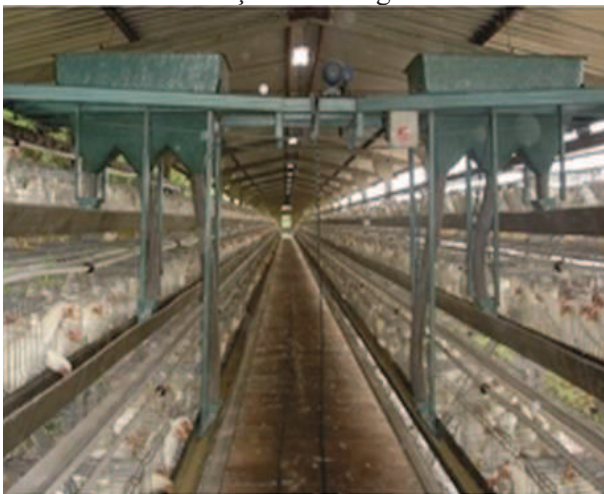
Figura 13: Automação em sistema convencional sistema de alimentação - Visão geral
