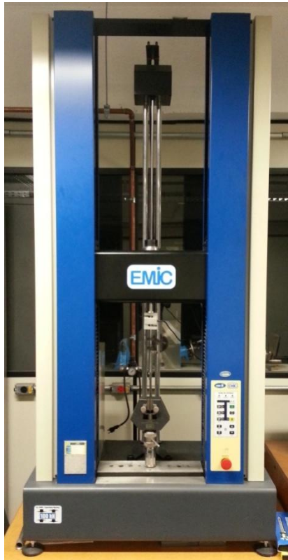
Figura 28. Máquina universal de ensaios modelo DL10.000, marca EMIC.
