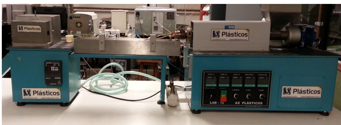
Figura 20. Micro-extrusora de monorrosca.
