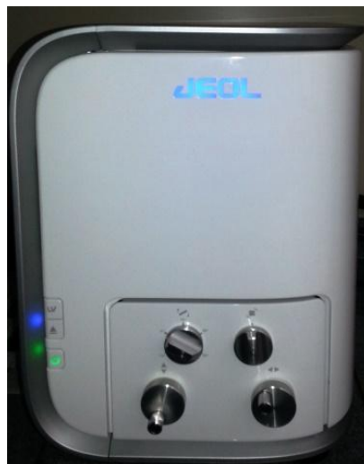
Figura 31. MEV de bancada da Marca Jeol Modelo J6000.
