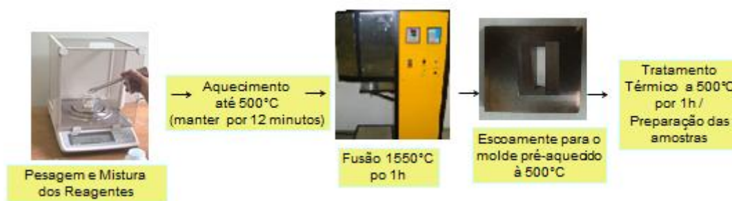
Figura 15. Sequência para a produção de vidro de borossilicato utilizando cadinho com tampa.
