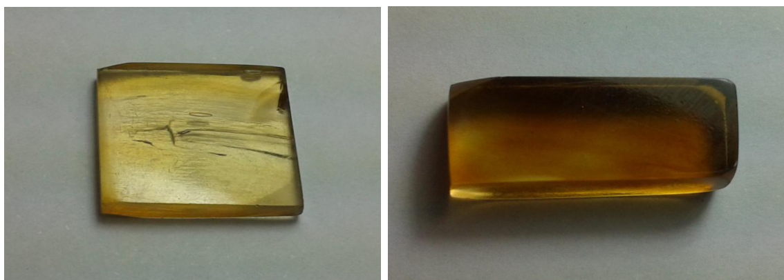
Figura 9. Vidro produzido com sílica da CCA (esquerda) e com sílica metalúrgica (direita).
