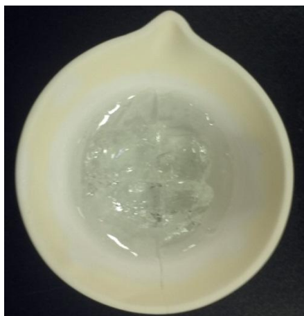
Figura 11. Vidro de borossilicato produzido a partir da CCA após 6 horas de fusão.
