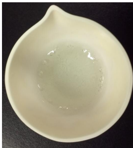
Figura. 14. Vidro de borossilicato produzido a partir da CCA calcinada após 2 horas de fusão.
