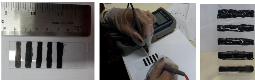
Figura 17: amostra preparada para medir a condutividade da mistura PAN/Vulcan
