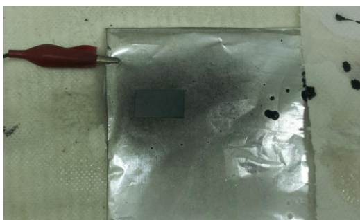
Figura 15: Foto das fibras com partículas de Vulcan depositadas no coletor pelo processo de electrospinning .
