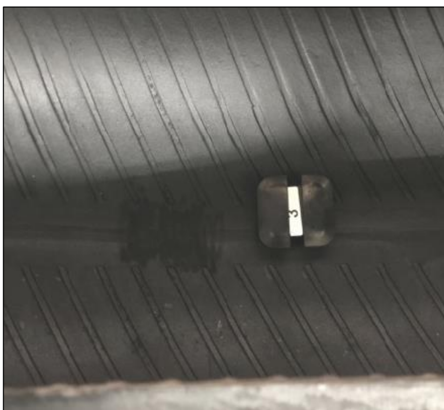
Figura 14 - Sensor TPMS instalado no pneu
