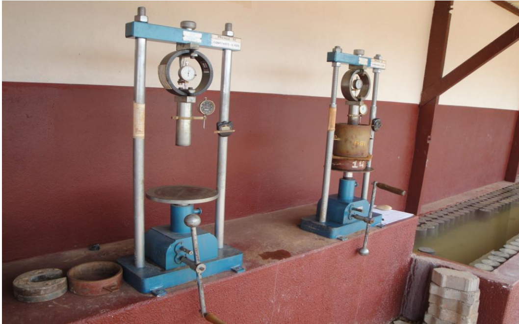
Figura 5.1: Prensas utilizadas para ruptura de corpos de prova Fonte: PRÓPRIA [2013]
