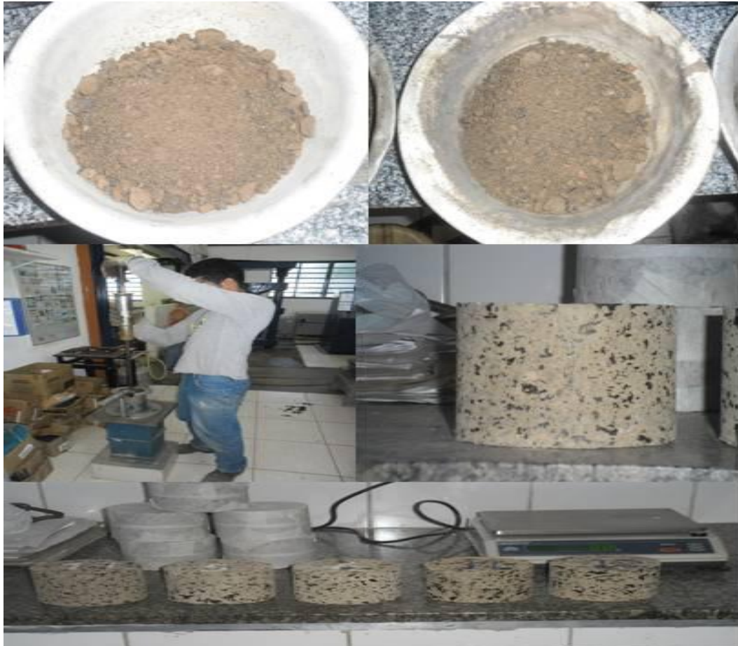
Figura 5.3: Montagem de corpos de prova Fonte: PRÓPRIA (2014)
