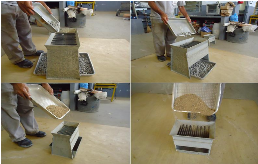
Figura 5.2: Quarteamento de amostra Fonte: PRÓPRIA [2013]
