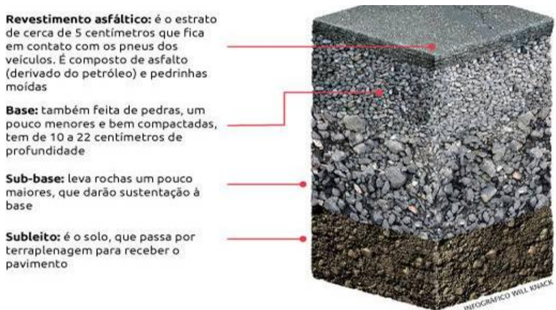
Figura 2.1: Camadas do pavimento Fonte: SALVO E DUARTE (2011)
