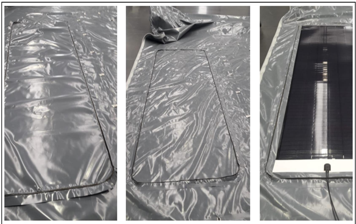
Figura 39 - Protótipos para fixação da placa fotovoltaica com zíper
