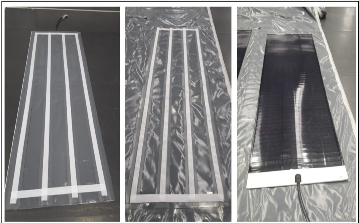
Figura 38 - Protótipos para fixação da placa fotovoltaica com velcro
