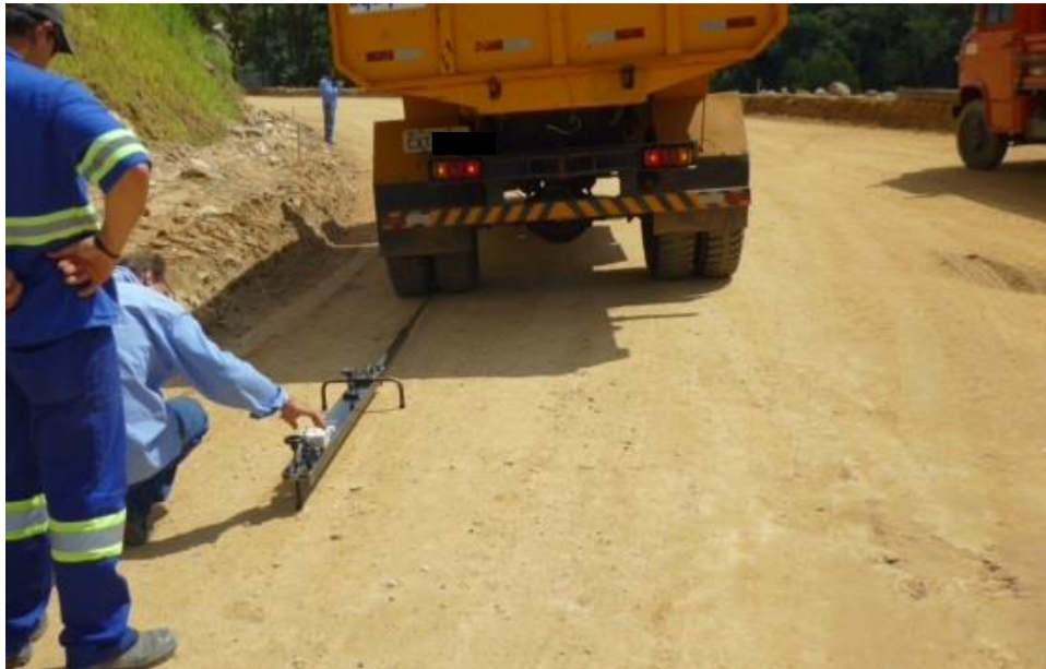
Figura 3.5 – Ensaio com a Viga Benkelman Fonte: PRÓPRIA (2013)
