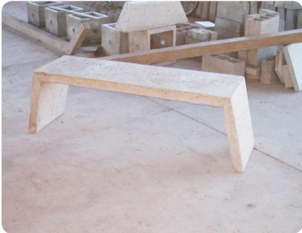
Figura 4.11 – Confeccção de mobiliário urbano com agregados reciclados Fonte: LIMA, R. S; LIMA RUY. R. R. (2012).
