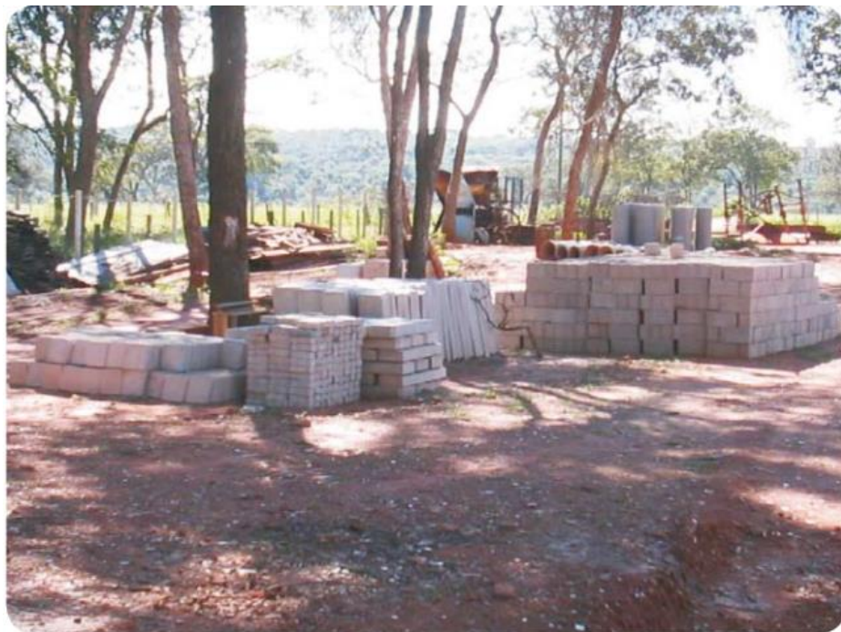
Figura 4.12 – Confeccção de blocos com agregados reciclados Fonte: LIMA, R. S; LIMA RUY. R. R. (2012).
