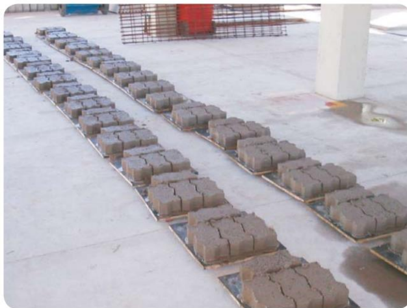
Figura 4.10 – Confecção de pavers com agregados reciclados Fonte: LIMA, R. S; LIMA RUY. R. R. (2012).
