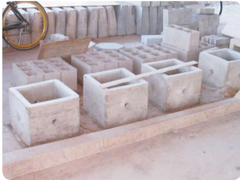
Figura 4.9 – Confecção de caixas de gordura com agregados reciclados Fonte: LIMA, R. S; LIMA RUY. R. R. (2012)
