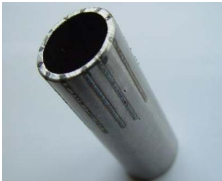
Figura 13 - Corpo de prova soldado. Fonte: [1]
