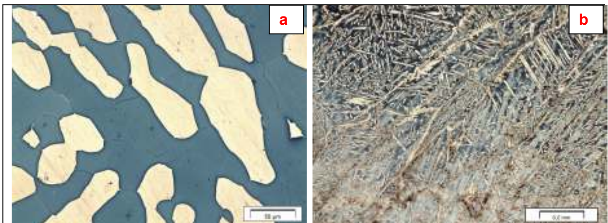
Figura 7 – Microestruturas dos aços duplex. (a) metal base. Aumento: 500x e (b) zona de fusão em soldagem. Aumento: 100x. Fonte: Autor
