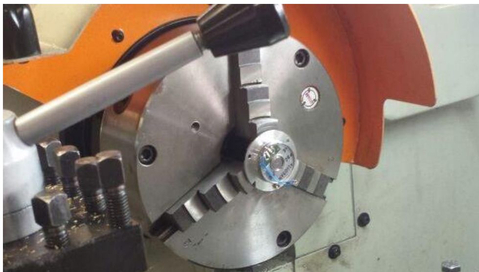
Figura 45 - Tentativa de furação do eixo do motor com torno.
