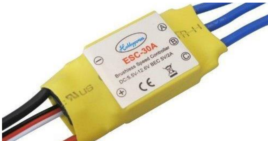
Figura 40 - ESC (Eletronic speed control)
