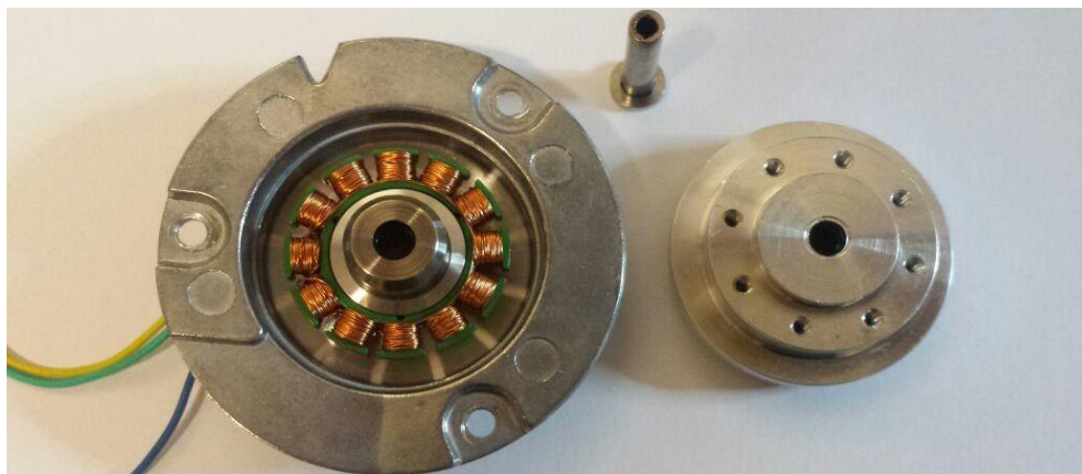
Figura 47 - Motor desmontado e eixo central perfurado.
