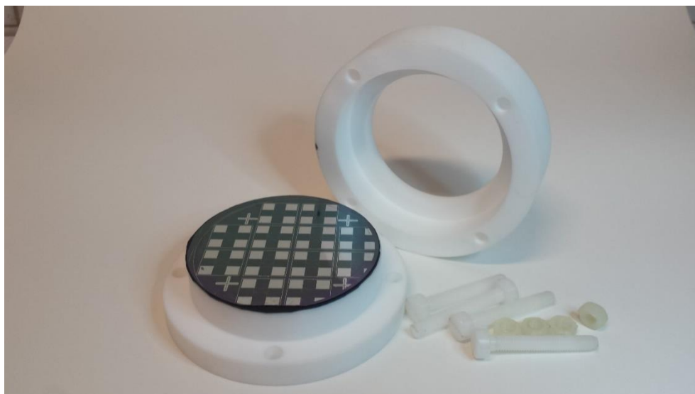
Figura 21 - Posicionamento da lâmina no suporte.
