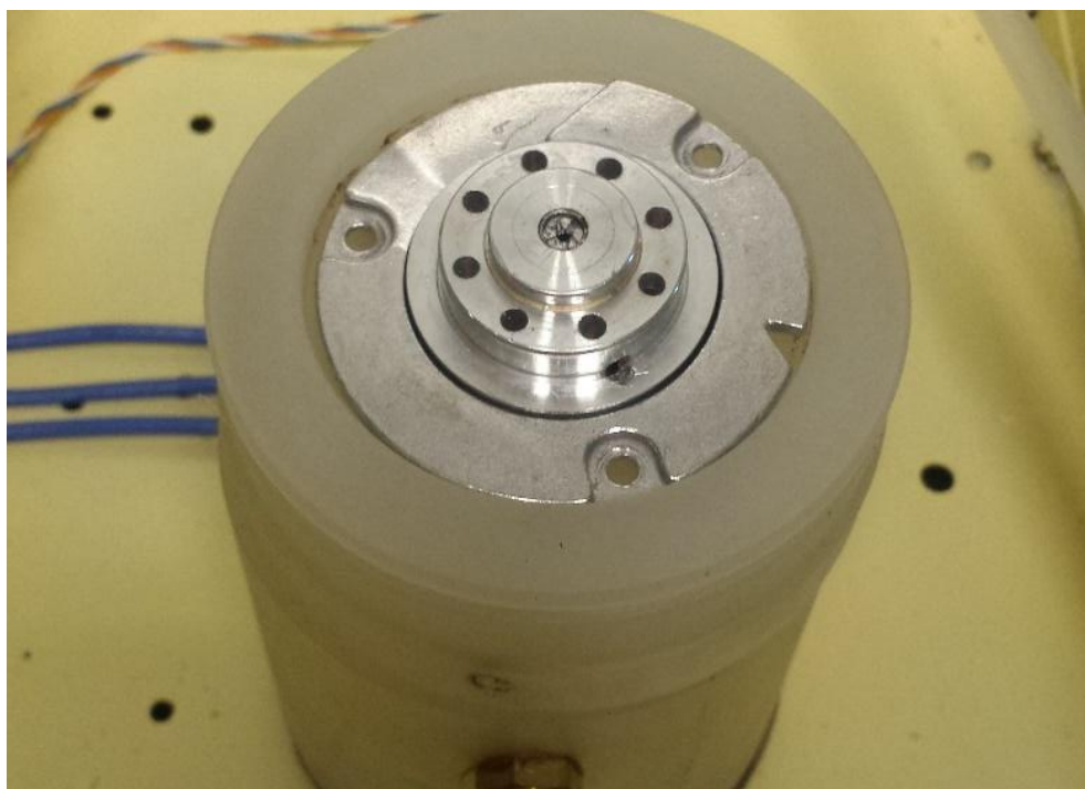
Figura 48 - Base de polipropileno para fixação do motor no sistema de vácuo.
