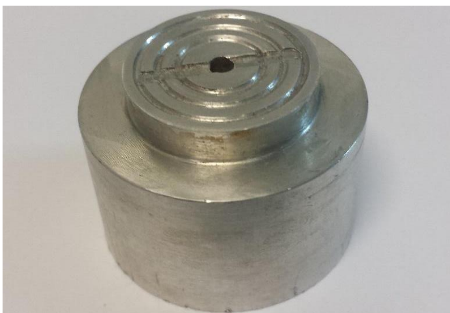
Figura 50 - Chuck para fixação da lâmina de silício.
