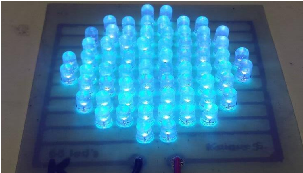
Figura 52 - Arranjo com 68 LEDs de U.V.
