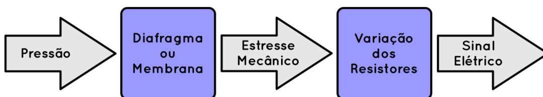
Figura 2 - Diagrama de blocos expondo o funcionamento do sensor de pressão.
