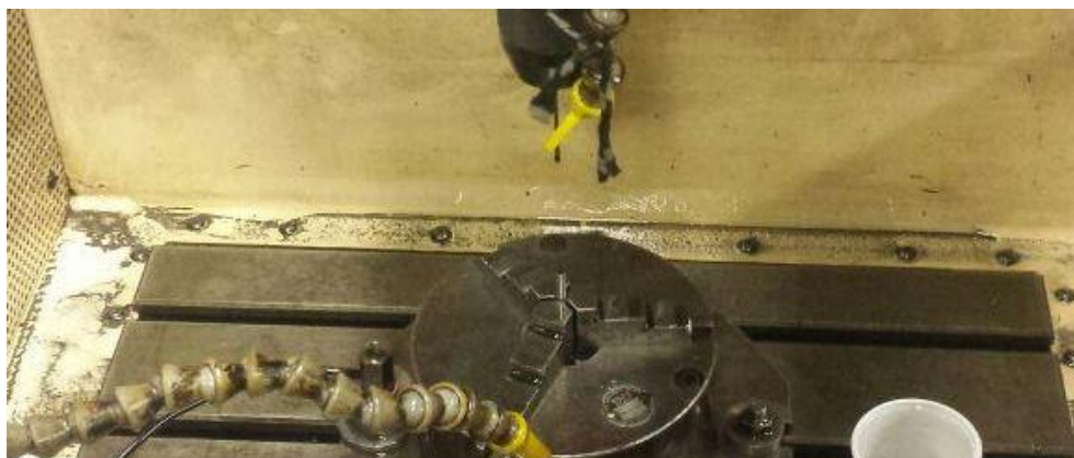
Figura 46 - Processo de eletroerosão para a furação do eixo do motor de HD
