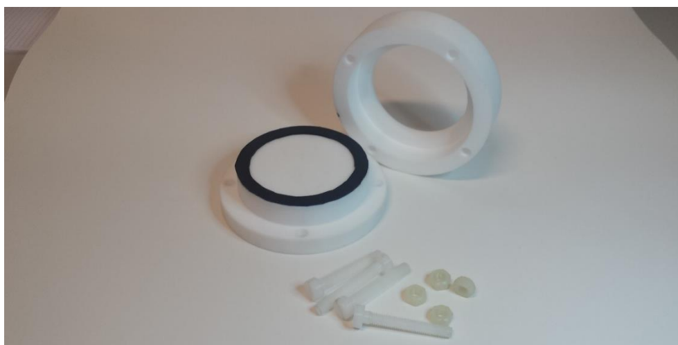
Figura 20 - Posicionamento do anel na base do suporte.
