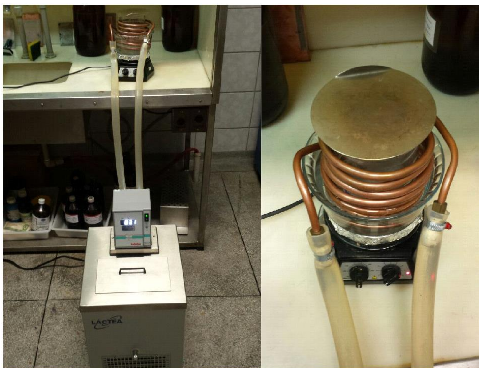
Figura 18 - Circulador e arranjo para manter a solução aquecida.
