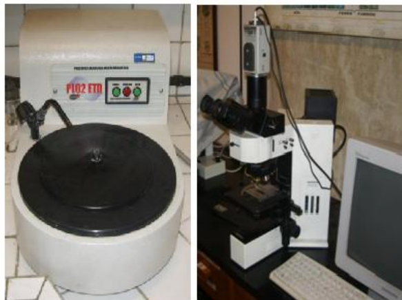
Figura 22 - À esquerda: Politriz Lixadeira Metalográfica. À direita: Microscópio Óptico com aumento de 50 a 1000x.
