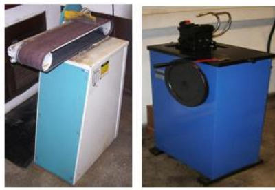
Figura 21 - À esquerda: Lixadeira de cinta. À direita: Brochadeira para confeccionar o entalhe no corpo de prova tipo Charpy.
