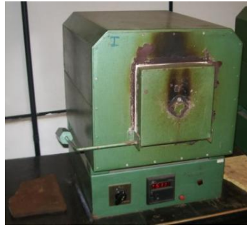
Figura 19 - Modelo do forno utilizado para o tratamento de Normalização.
