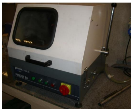
Figura 18 - Modelo da máquina de corte ("Cut-off")
