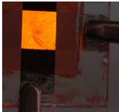
Figura 30: Área ativa de 9 x 9 mm de um dispositivo OLED que apresenta sinais de degradação (pontos escuros).
