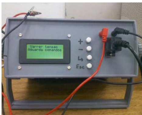
Figura 38: Fonte de energia utilizada para obtenção das curvas de corrente elétrica x tensão dos dispositivos OLEDs .
