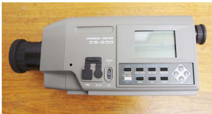
Figura 39: Colorímetro para obtenção da luminância dos dispositivos OLEDs .
