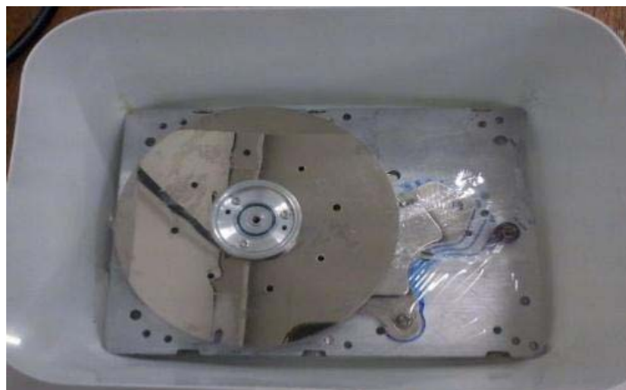
Figura 17: Spinner montado com motor de disco rígido (HD).
