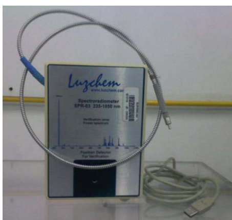
Figura 37: Espectrorradiômetro com cabo de fibra óptica e saída USB.
