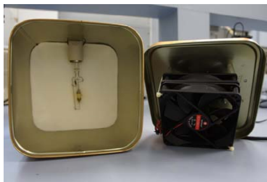
Figura 22: Reator de UV-Ozônio com lâmpada de 80 watts.
